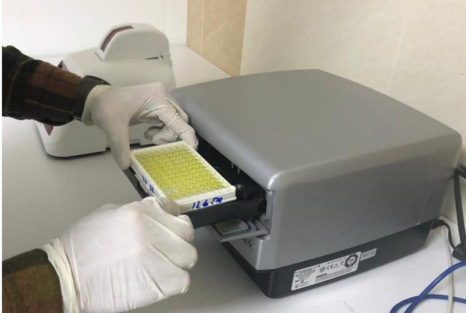
Resim 17. Hazırlanma işlemleri tamamlanmış mikrolakanın mikroplaka okuyucu spektrofotometreye yerleştirilmesi.
