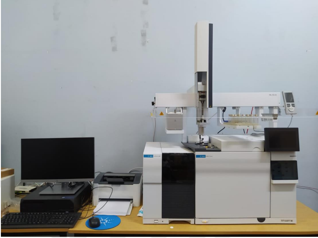
Resim 4. Çalışmada kullanılan GC-MS cihazı ve numunelerin cihaza yerleştirilmesi.
