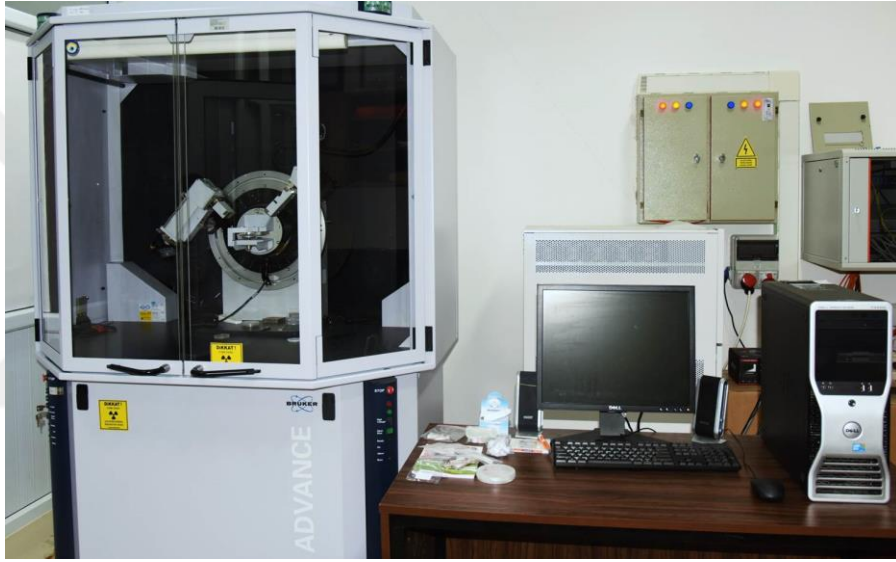
Şekil 3.1. BRUKER D8 ADVANCE model difraktometre
