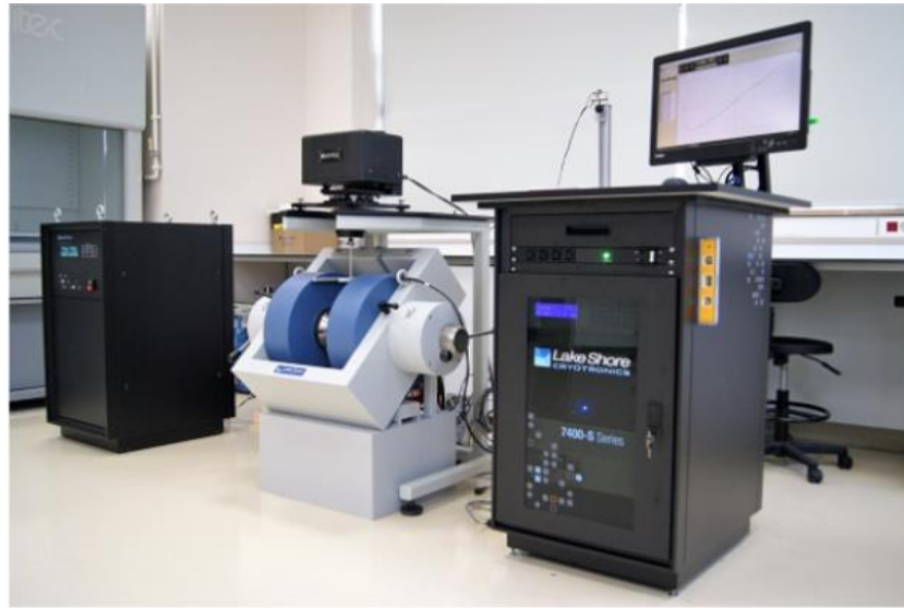
Şekil 3.3. Titreşimli numune magnetometresi (Lake Shore Cryotronics, 7407-S)
