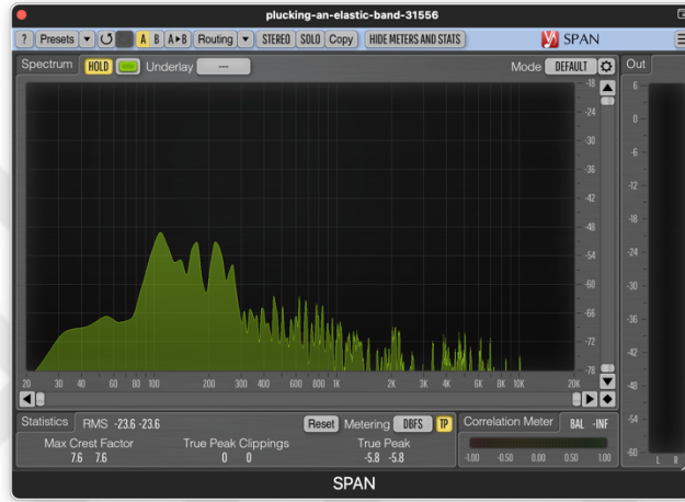
Görsel 24. Elastik bandın çekilme sesine ilişkin SPAN analiz çıktısı
