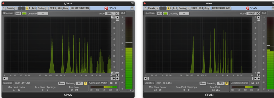
Görsel 23. Oluşturulan sesin (solda) ve normal obua sesinin (sağda) La4 (440 Hz) notası üzerindeki frekans spektrumunun SPAN ile karşılaştırılması
