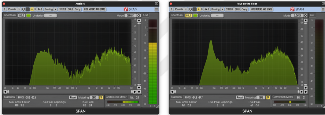
Görsel 37. Oluşturulan sesin (solda) ve normal trampet sesinin (sağda) frekans spektrumunun SPAN ile karşılaştırılması
