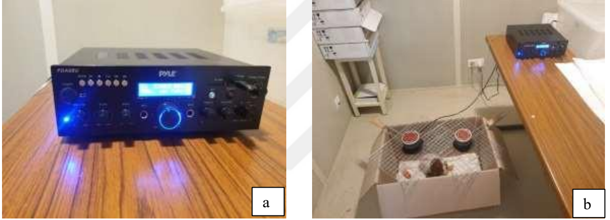
Şekil 1. Gürültü modellemesi oluşturmak için kullanılan amplifikatör sistem (a) ve gürültü uygulaması sırasında alınan bir kayıt görüntü(b)
