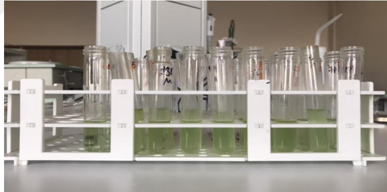
Şekil 4.1. ABTS antioksidan tayin yönteminde oluşan bulanıklık.
