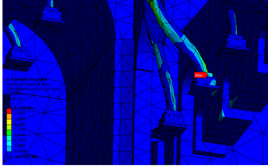
Şekil 5.37. Erzincan (N-S) depremi maksimum asal çekme gerilmeleri
