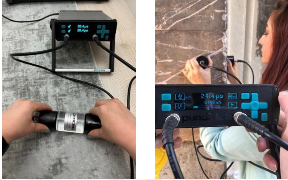
Şekil 4.14. Proceq ultrases cihazı kalibrasyon işlemi ve Ultrases cihazı ile yarı direkt okuma
