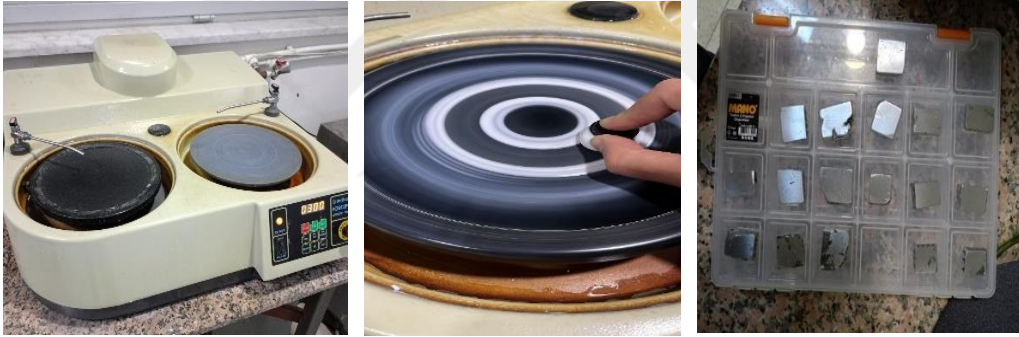
Şekil 5.7 Mikroyapı incelemeleri için hazırlanan numuneler
