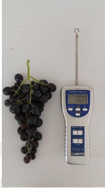
Şekil 3.11. ‘Alphonse Lavallée’ üzüm çeşidinde saptan kopma (N) ve kabuk yırtılma (N) ölçümünde kullanılan Lutron FG-5020 dinamometre cihazı
