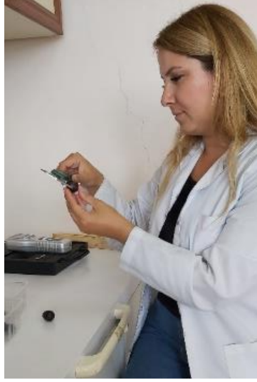
Şekil 3.10. ‘Alphonse Lavallée’ üzüm çeşidinde dijital kumpasla tane uzunluk ve genişlik ölçümü
