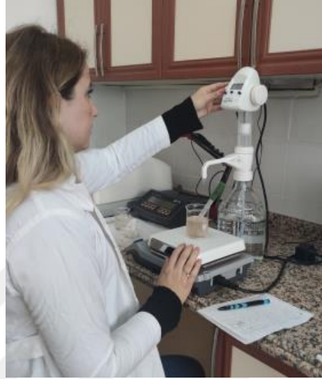
Şekil 3.12. ‘Alphonse Lavallée’ üzüm çeşidinde titre edilebilir asitlik (TA) (%) ölçümü
