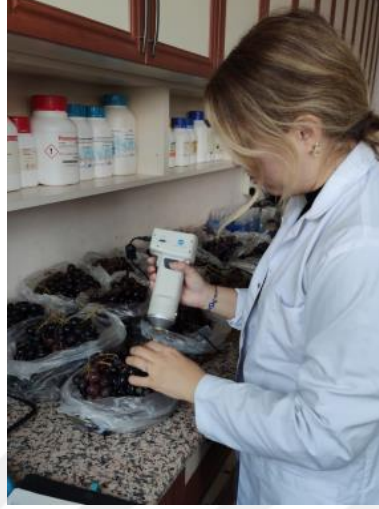
Şekil 3.13. ‘Alphonse Lavallée’ üzüm çeşidinde tane kabuk rengi ölçümü
