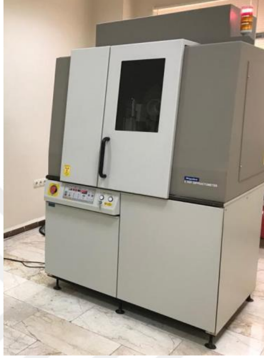
Şekil 3.12. XRD analizinde kullanılan cihaz.
