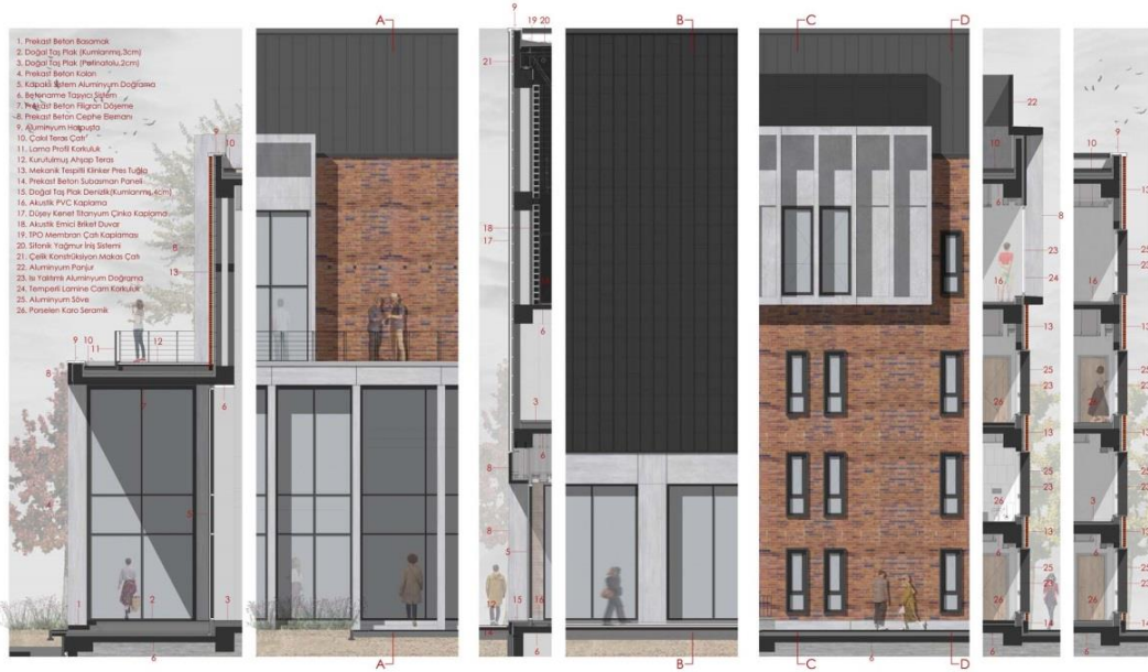
Şekil 4. 16 :Cephe malzeme listesi (Url-22).
