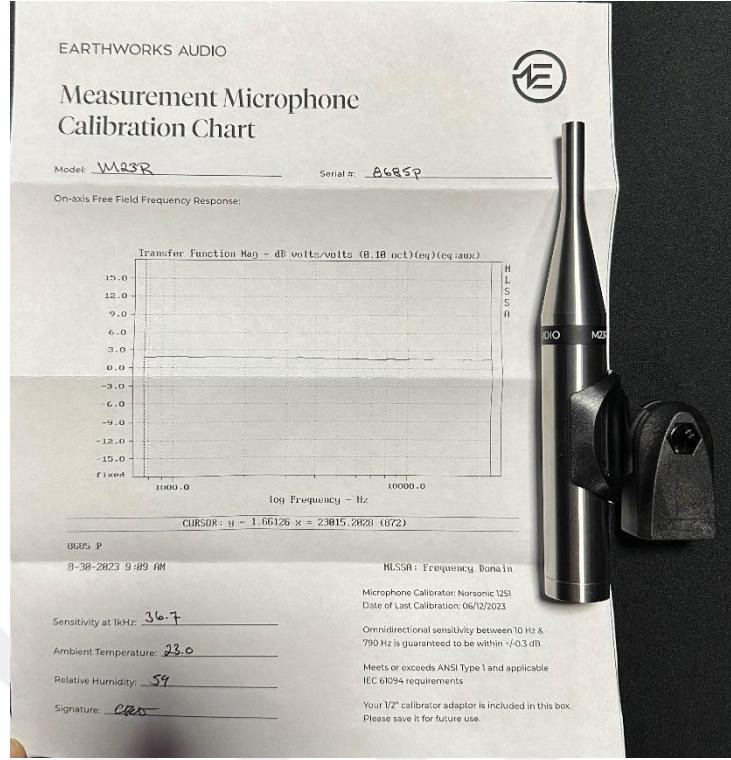
Şekil 4.6 : Kullanılan Earhtworks marka M23R model mikrofön ve ölçüm kalibrasyon belgesi.
