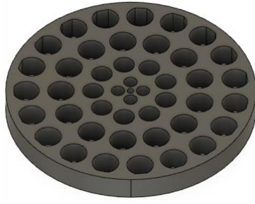
Şekil 3.43 : Farklı çaplarda daire delikli ( \emptyset 0,8 - \emptyset 1,62 - \emptyset 2,51 mm) ızgara görseli.
