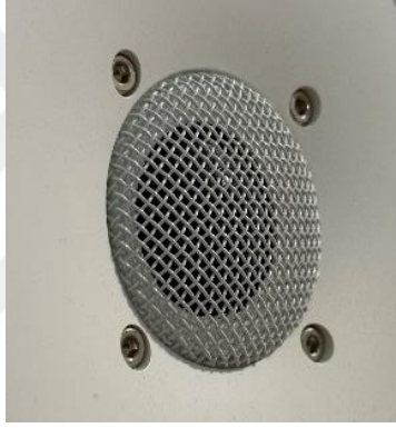
Şekil 1.3 : Yüksek frekans üreten hoparlör (tweeter) önünde bulunan tel örgü ızgara.
