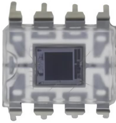
Şekil 3.7 : OPT101 ve pin diyagramı [55]
