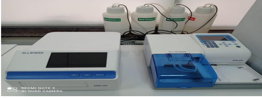
Resim 3.5 Çalışmada kullanılan ELISA plate okuyucu ve otomatik yıkama cihazı
