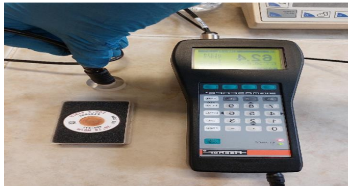
Şekil 3.7: Fischer Sigmascope elektrik iletkenlik probu
