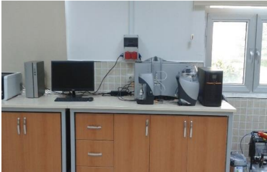
Şekil 3.4: Malvern Mastersizer 3000 parçacık boyut ölçüm cihazı
