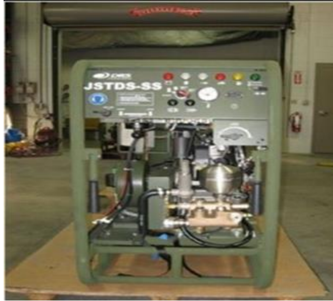
Şekil 6.59: M26 Dekontaminasyon Sistemi
