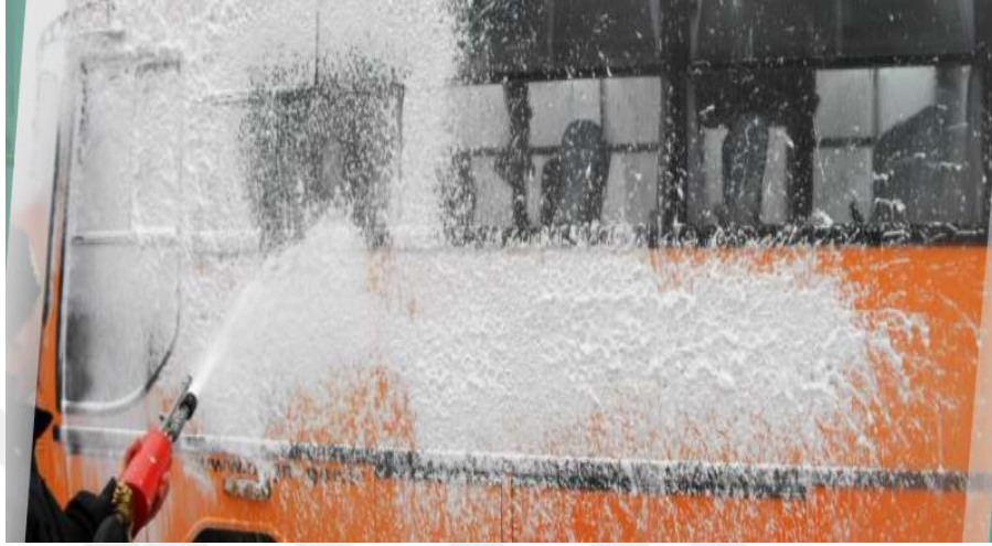
Şekil 6.110: Arazi ve Araç Dekontaminasyon Ünitesi
