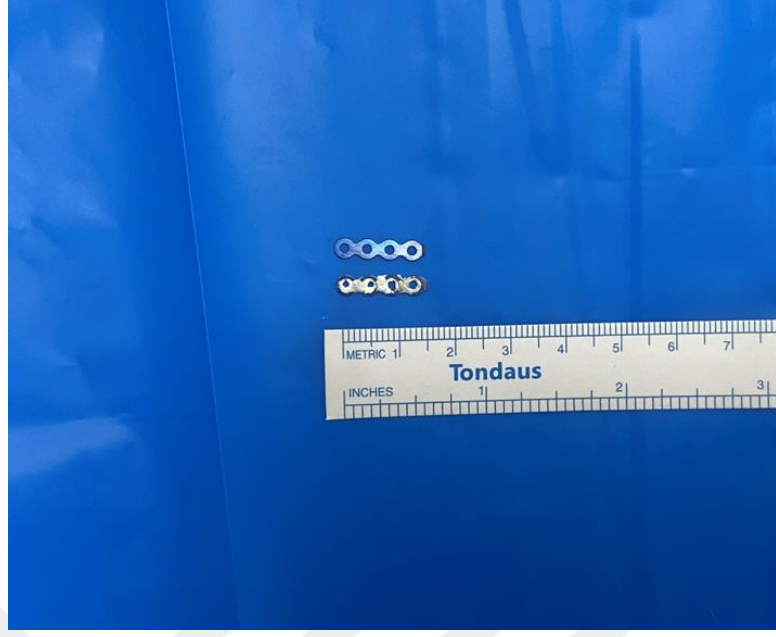
Resim 8: 15mmx3mmx1mm boyutlarındaki standart plak ve bor nitrür-borik asit kompoziti kaplı plak
