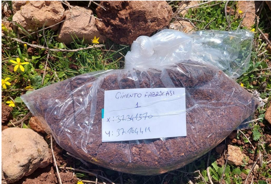
Şekil 2.5 Toprak numunelerinin alınması, paketlenmesi ve adlandırılması. (Çimento Fab.)
