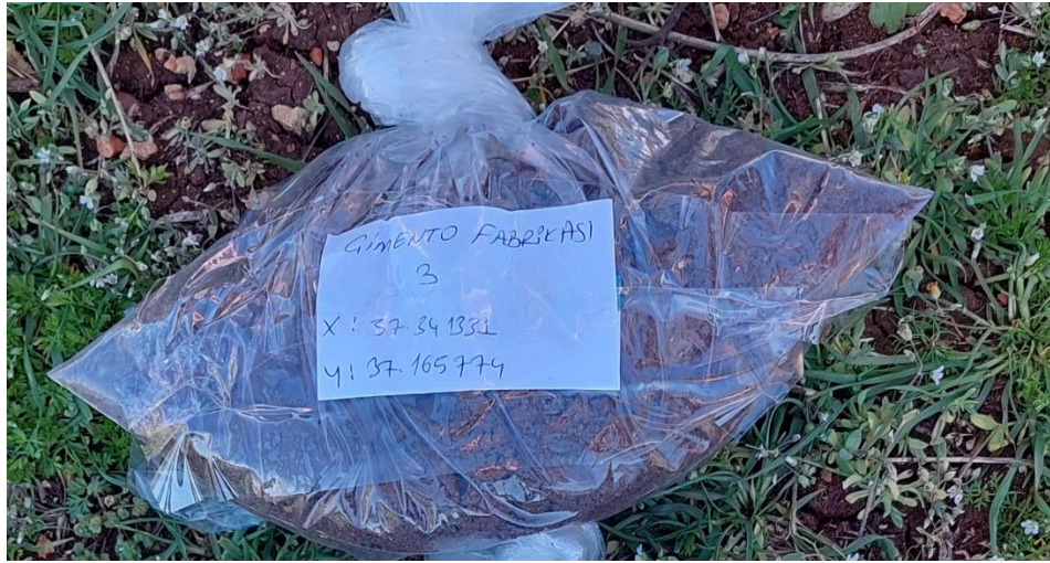
Şekil 2.7 Toprak numunelerinin alınması, paketlenmesi ve adlandırılması. (Çimento Fab.)
