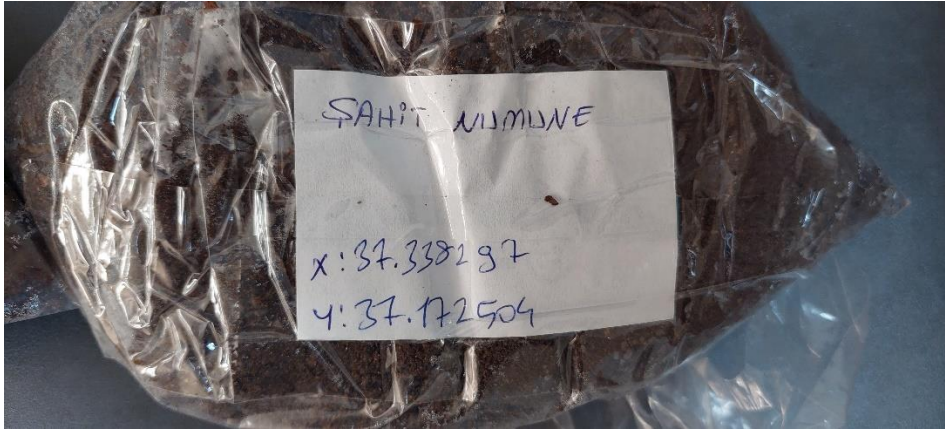
Şekil 2.8 Toprak numunelerinin alınması, paketlenmesi ve adlandırılması. (Çimento Fab.)
