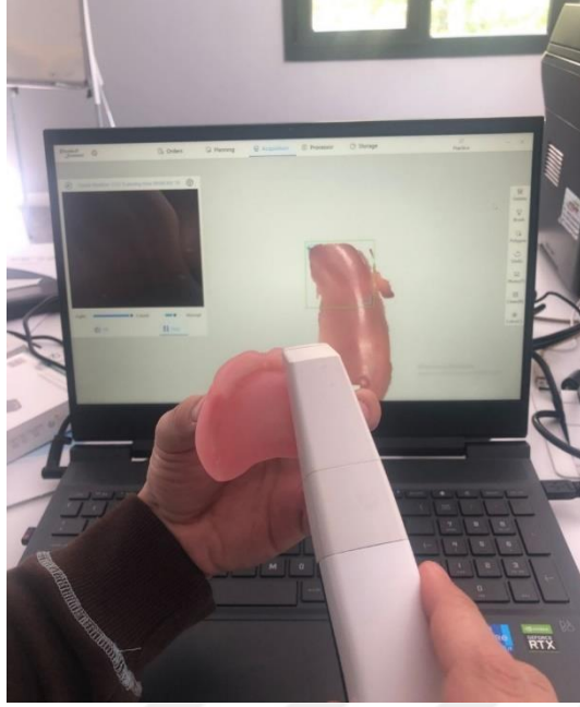
Şekil 3.16. Üretimi tamamlanan kaidelerin tarama işleminin yapılması
