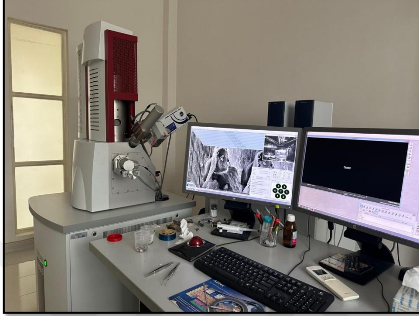
Şekil 3.18. Taramalı elektron mikroskobu (Sem görüntüleme cihazı)
