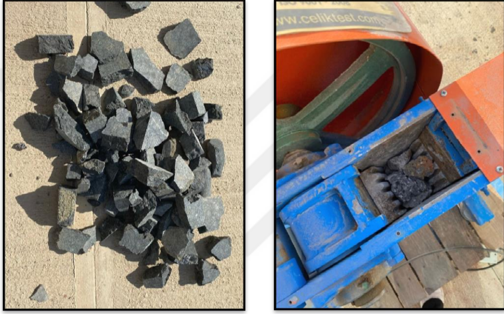
Şekil 3.6. Araziden temin edilen ve çeneli kırıcıda belirli tane boyutuna getirilen dolomit
