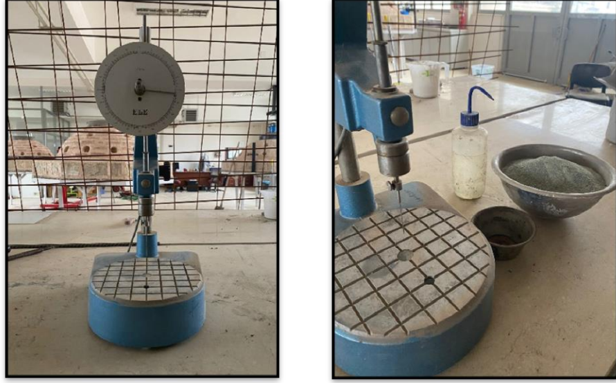
Şekil 3.20. Priz süreleri tayini için kullanılan vicat aleti
