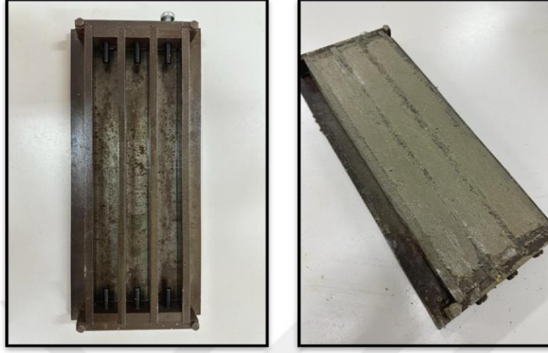
Şekil 3.16. Boy değişimi numune kalıbı ve numuneler
