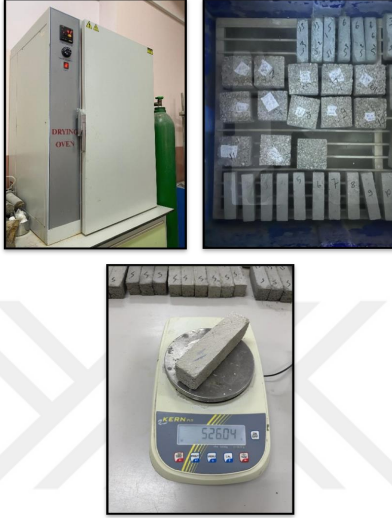
Şekil 3.12. Etüv cihazı, kür havuzunda bekleyen numuneler ve numunelerin tartılması
