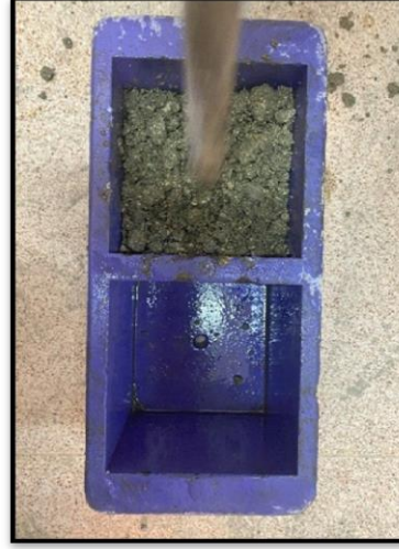
Şekil 3.8. Kalıba yerleştirilen ilk katman ve 25 kez yapılan şişleme işlemi
