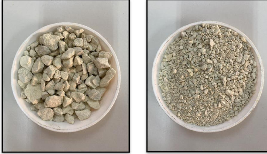
Şekil 3.1. Deneylerde kullanılan agrega; 4 mm üstü elekte kalan ve 4 mm altı elekten geçen
