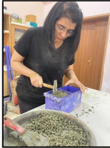
Şekil 3.9. Tokmaktama işlemi ve kalıplara yerleştirilen numuneler
