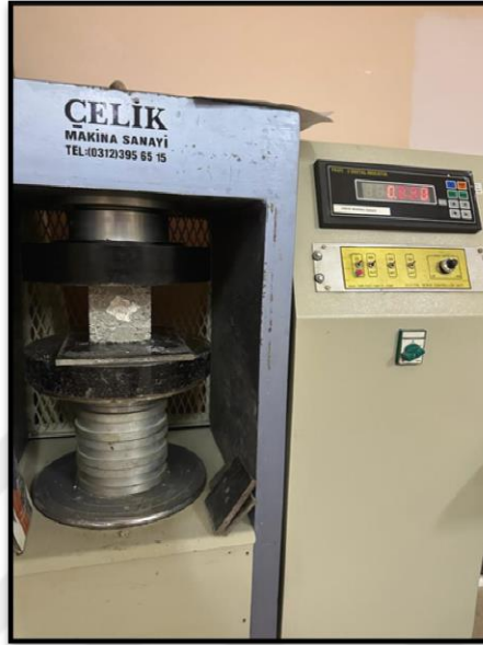
Şekil 3.11. Basınç dayanımı test cihazı
