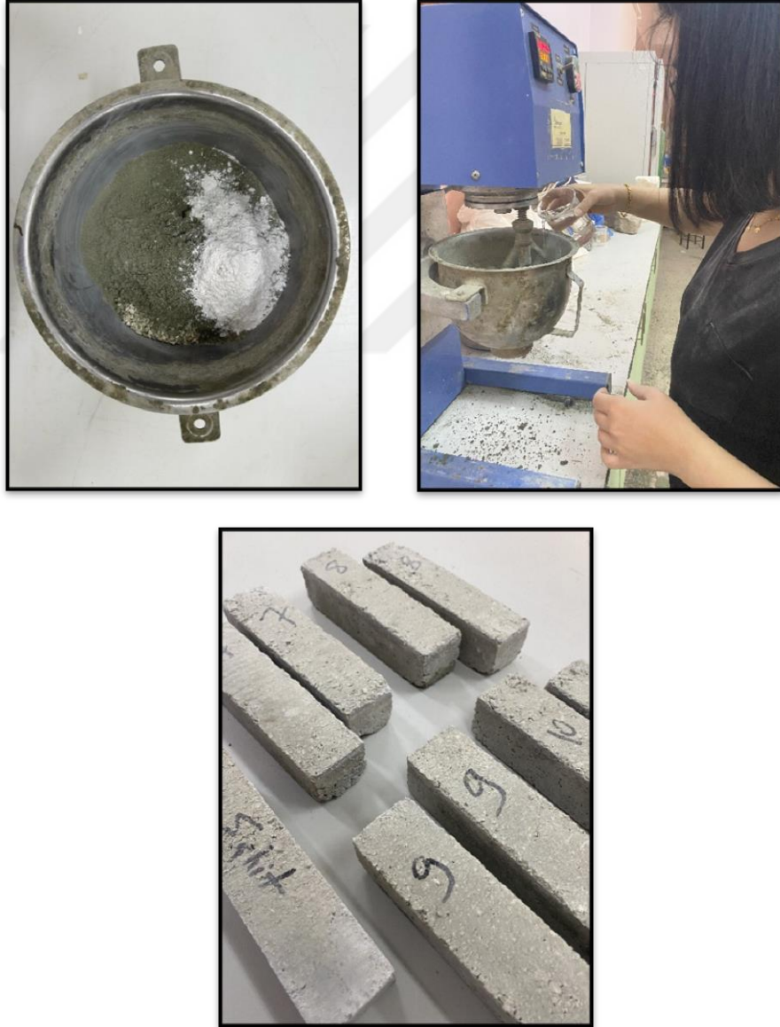
Şekil 3.10. Harç numunelerin hazırlanması
