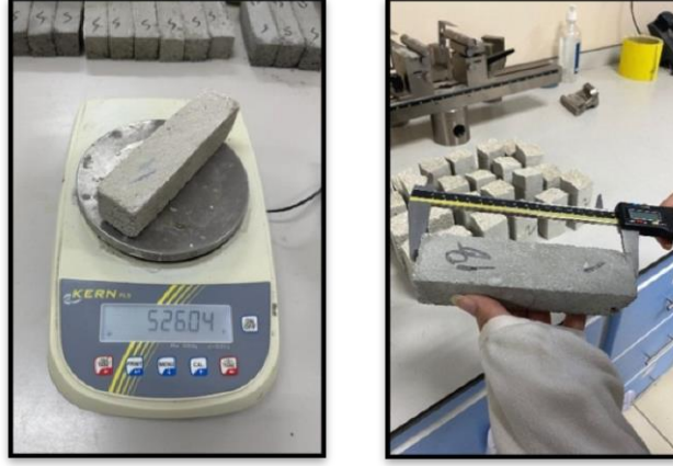
Şekil 3.13. Kuru ağırlıkların ölçümü ve kumpas yardımıyla hacim ölçümü
