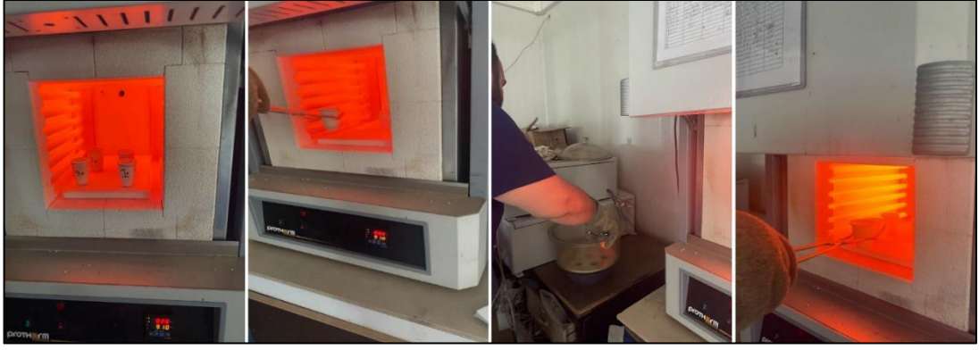
Şekil 3.10. Kül fırınında gerçekleştirilen uçucu katı madde analizleri
