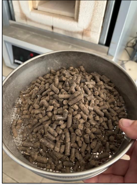
Şekil 4.4. Peletlerin partikül madde miktarının incelenmesi için elek (çap: 3.15 mm)
