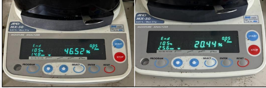
Şekil 4.8. KFÜ ve TKFÜ materyallerinin suya daldırılması sonrası ilk nem ölçümü
