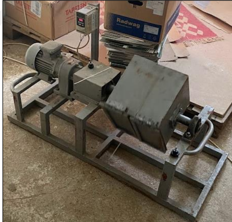
Şekil 3.13. Tumbler mekanik dayanım ölçüm cihazı
