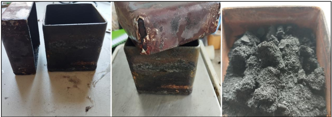
Şekil 3.21. Kimyasal empenye sonrası ısıtım işlemleri ile aktivasyonun tamamlanması
