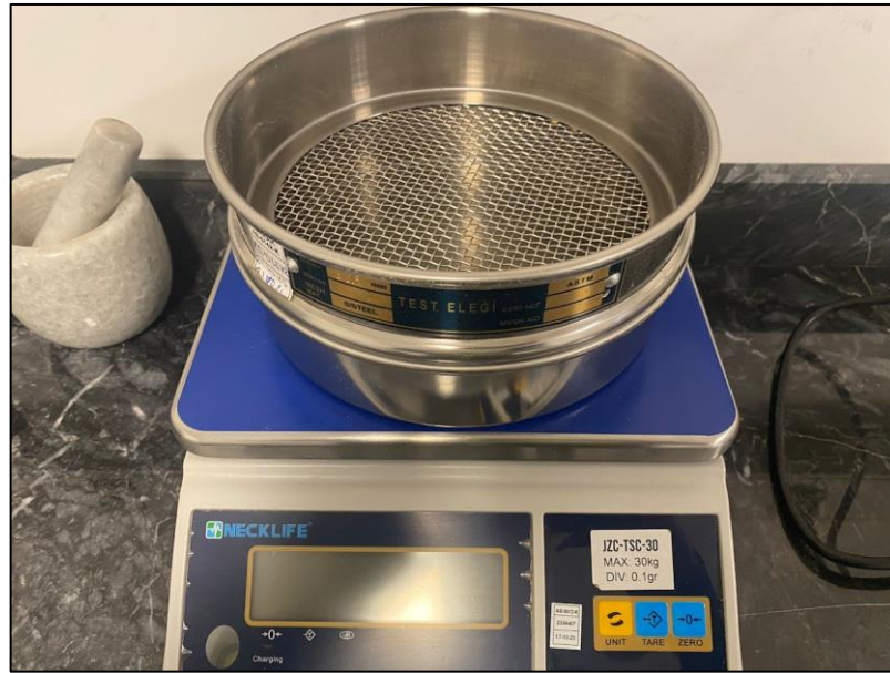
Şekil 3.12. Hassas terazi ve elek düzeneği
