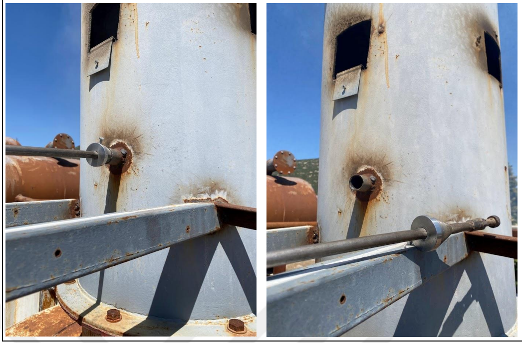
Şekil 3.19. Akışkan yataklı kazanda bacadan emisyon değerlerinin ölçülmesi
