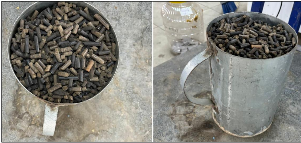
Şekil 4.9. KFÜ ve TKFÜ peletlerinin yığın yoğunluğunun belirlenmesi
