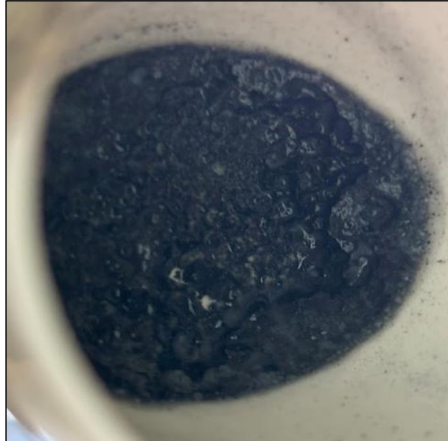
Şekil 4.44. KFÜ-H 3 PO 4 materyalinin krozedeki yakılması ile geriye kalan tahrip edilmiş ve krozeden ayrıştırılamayan biyokütle materyali
