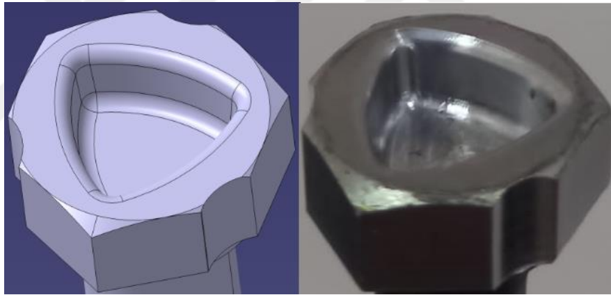
Şekil 2.4 : Felix cıvatasının BDT’deki ve gerçekteki izometrik görünüşleri.
