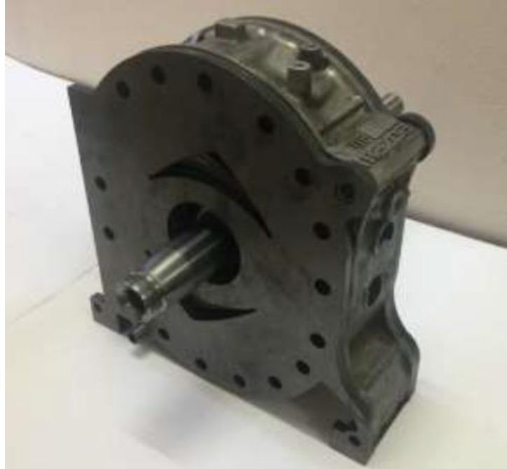
Şekil 5.1 : Montajı yapılmış iki zamanlı prototip Wankel motoru.
