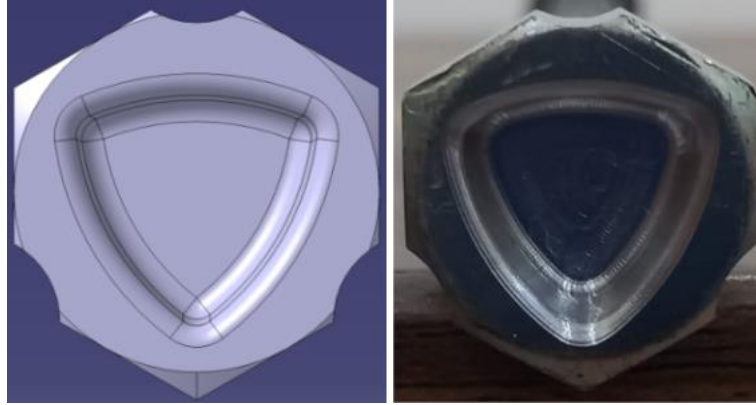
Şekil 2.3 : Felix cıvatasının BDT’deki ve gerçekteki karşıdan görünüşleri.
