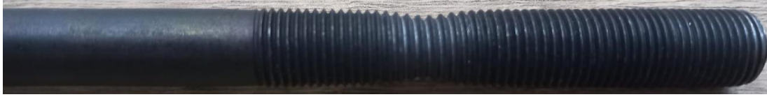
Şekil 4.3 : Çekme deneyinden sonra Felix saplamasının boyun veren gövdesi.
