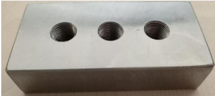
Şekil 3.5 : M10x1 dişli kör deliklere sahip aparat.
