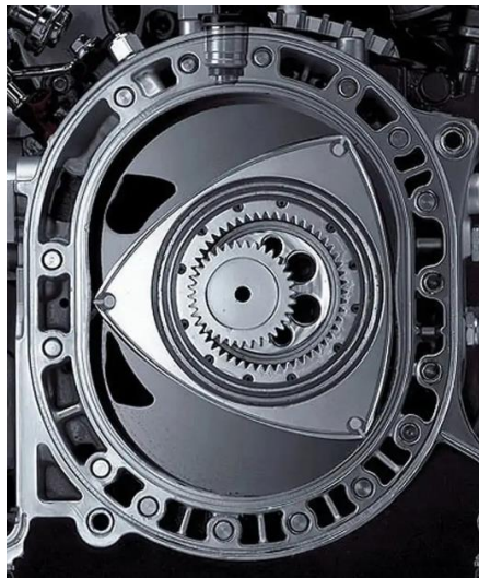
Şekil 5.4 : ÜÖN'da Wankel motoru yanma odasının görünümü.
