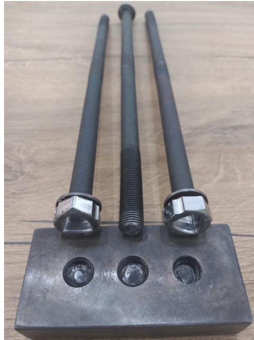
Şekil 4.9 : Burulma deneyi sonrası cıvatalar ve kör delikli aparat.
