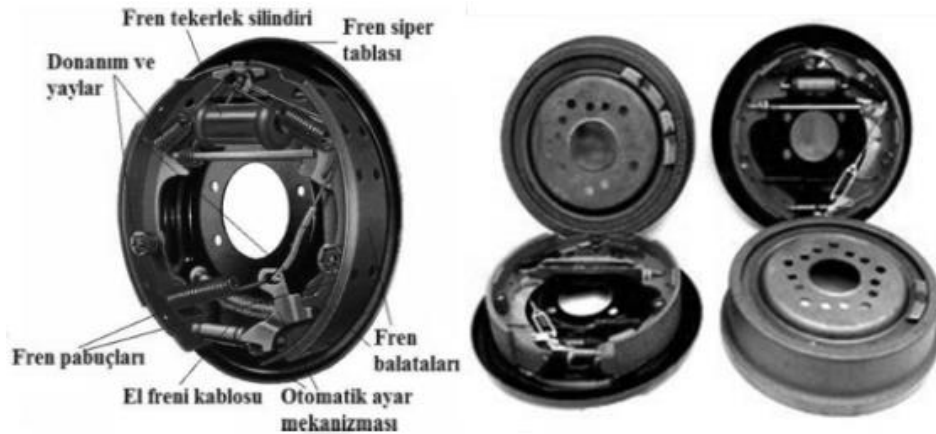
Şekil 1.16. Kampanalı fren sisteminin yapısı [31]
