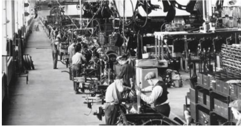
Şekil 1.4. Henry Ford'un ürettiği Model T otomobilinin seri üretim bandı [3]
