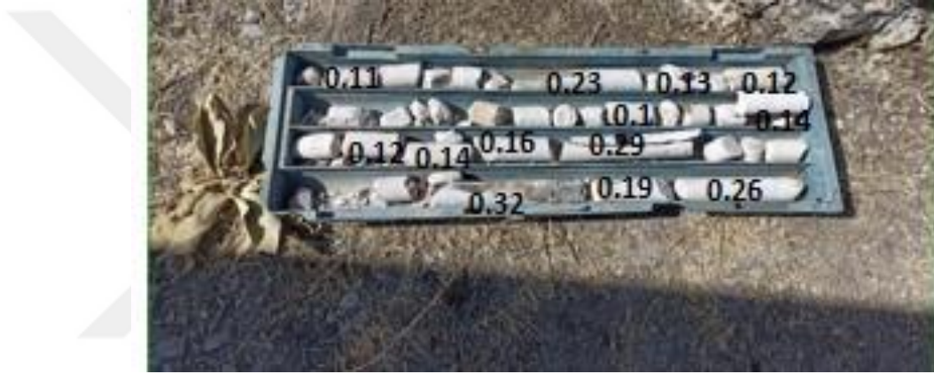
Şekil 8.12 Malatya ili Kuluncak ilçesi Bahçelievler mahallesi çalışma alanı sandığa alınan numuneler
