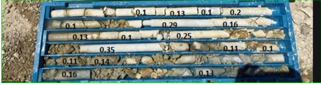
Şekil 8.4 Malatya ili Kuluncak ilçesi Bahçelievler mahallesi çalışma alanı sandığa alınan numuneler
