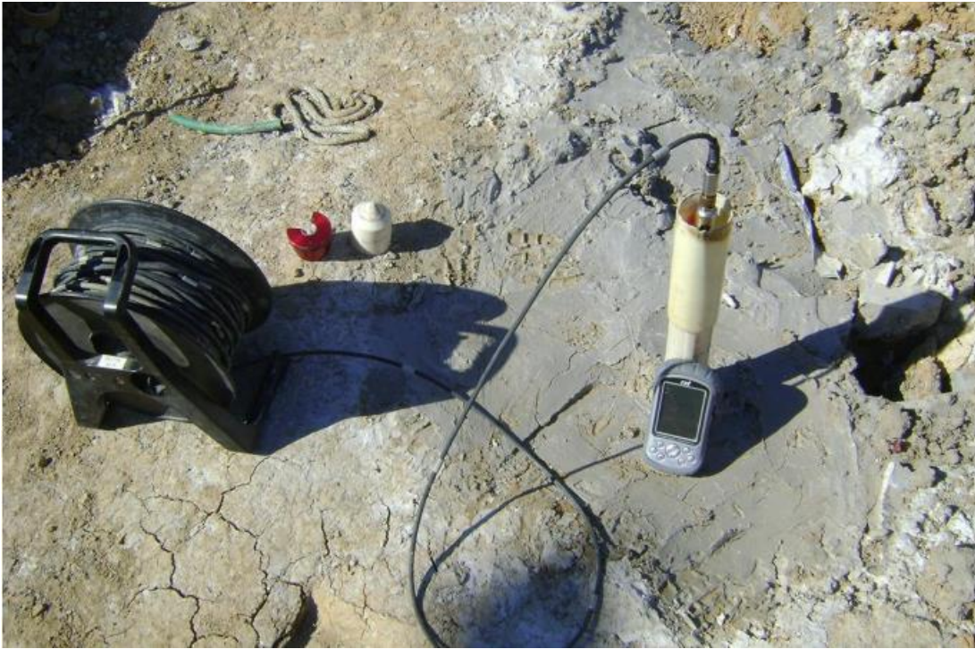
Şekil 3.9. İnklinometre deney düzeneğinin tamamlanmış hali
