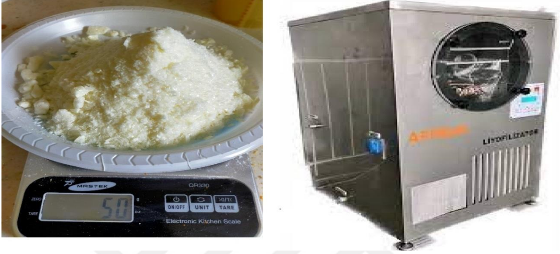
Fotoğraf 3.9. Laktozsuz liyofilize süt tozu (solda) ve liyofilizatör cihazı (sağda) (orijinal)
