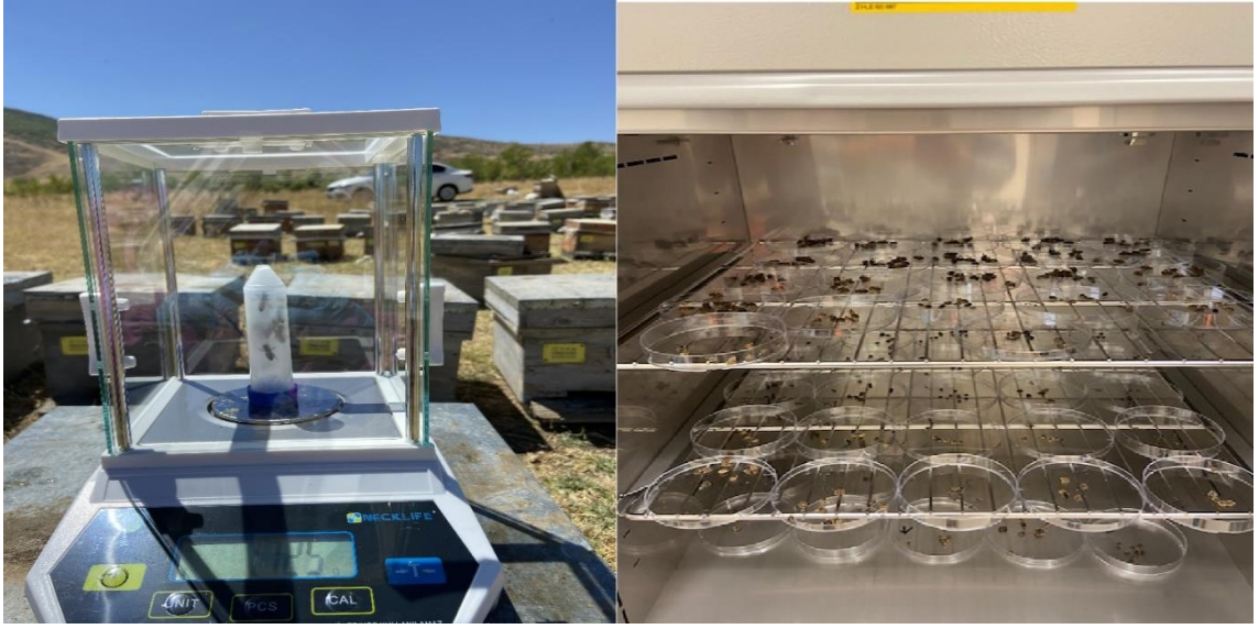
Fotoğraf 3.26. Ergin işçi arıların tüm vücut ve parçalarının ıslak ve kuru ağırlık ölçümü (orijinal)
