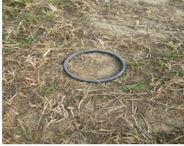
Resim 4.1. Parsele çakılmış CO 2 ölçüm kasnağı
