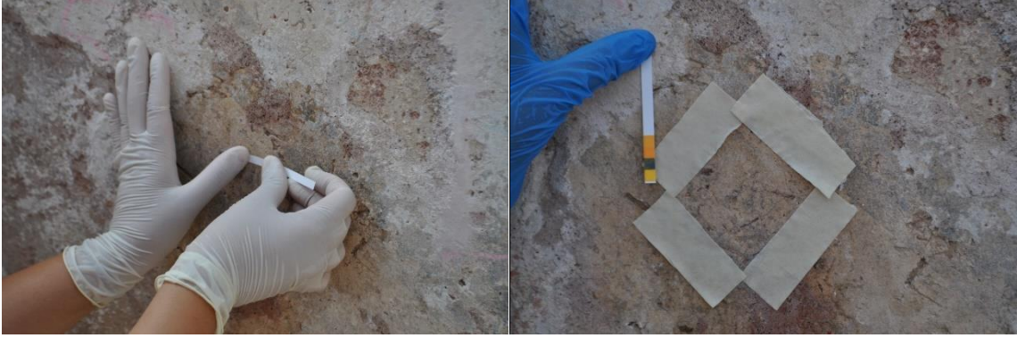
Resim 98-99: Kimyasal Paketleme Sonrası Duvarın pH'ının Ölçülmesi (Büşra Al'ın Arşivi 2023)
