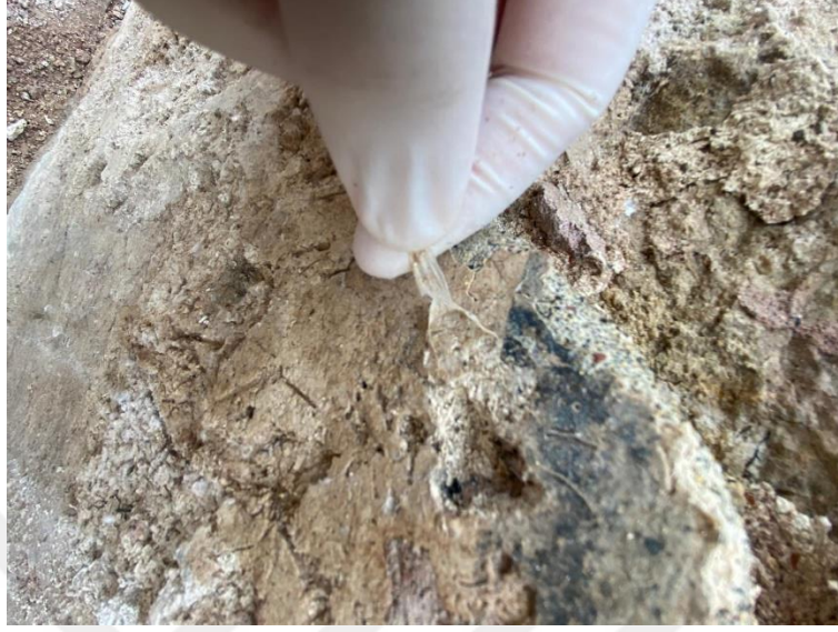
Resim 78: Yüzeyde Yoğun Paraloid Varlığı ve Paraloid'in Tabaka Halinde Soyulması (Büşra Al'ın Arşivi 2023)
