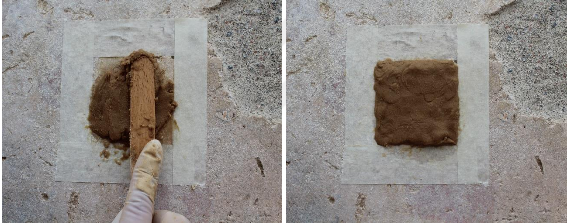
Resim 92-93: IONEX H Duvar Resimlerine Uygulanması (Büşra Al'ın Arşivi 2023)
