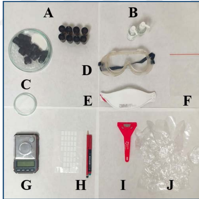
Şekil 21. DAGEM arılığında zehir kazıma işlemi sırasında kullanılan zehir kazıma kiti malzemeleri. A- Amber renkli cam şişe ve gıdaya uygun tıpa, B- %70 alkol, C- Zehir toplama cam petri kabı D- Laboratuvar gözlüğü, E- Maske, F- Şişe gruplama paketi, G- Hassas terazi, H- Etiket ve kalem, I- Cam kazıma aleti, J- Eldiven
