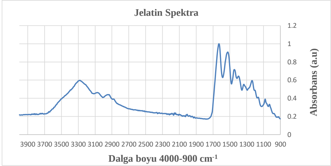
Şekil 4. 7: Jelatin Katkısının FTIR Spektrası (Absorbans) (FTIR spektragrafisi 3 bağımsız spektraların birleştirilmesi ile elde edilmiştir).
