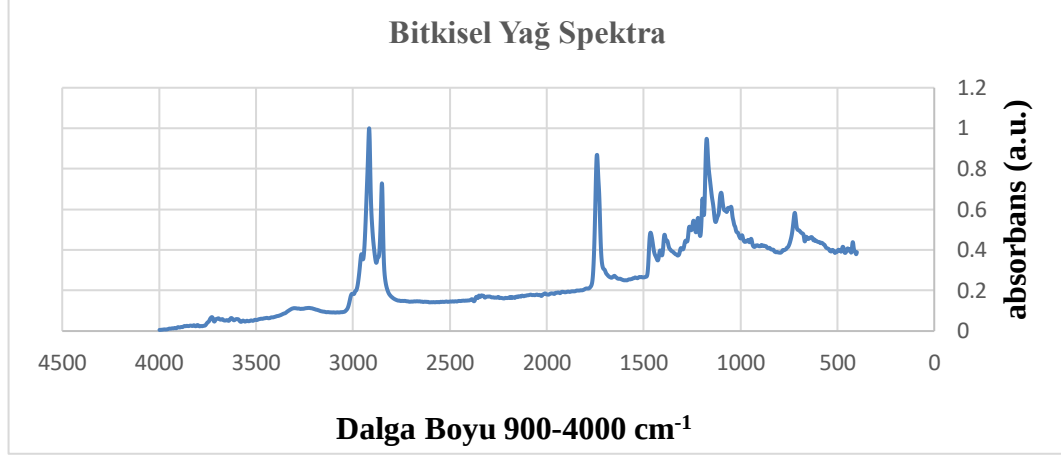
Şekil 4. 13: Bitkisel yağ katkısının FTIR Spektrası (Absorbans). (FTIR spektragrafisi 3 bağımsız spektraların birleştirilmesi ile elde edilmiştir).
