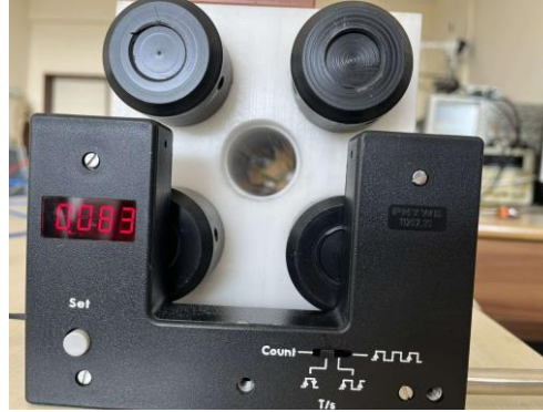
Şekil 3.10. 63 V DA giriş gerilimi ve 50 Hz çıkış frekansındaki sensörün ölçtüğü değer.
