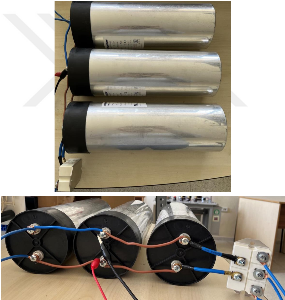
Şekil 2.67. Kontrolsüz köprü diyot doğrultucu ve DA bara kapasitörleri.
