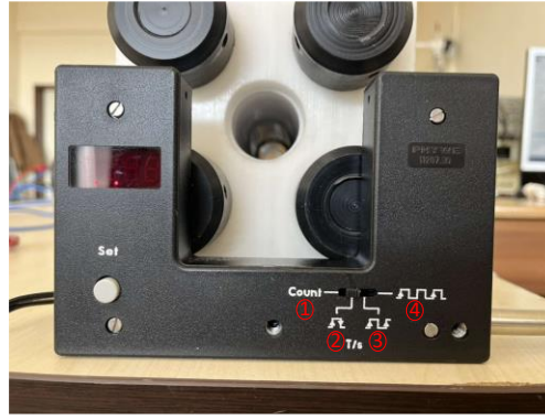
Şekil 3.8. Işık bariyerli sayıcının çalışma modları.
