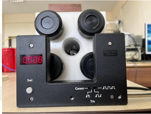
Şekil 3.23. 25 m/s hızla fırlatılan mermi için sensör tarafından ölçülen değer.
