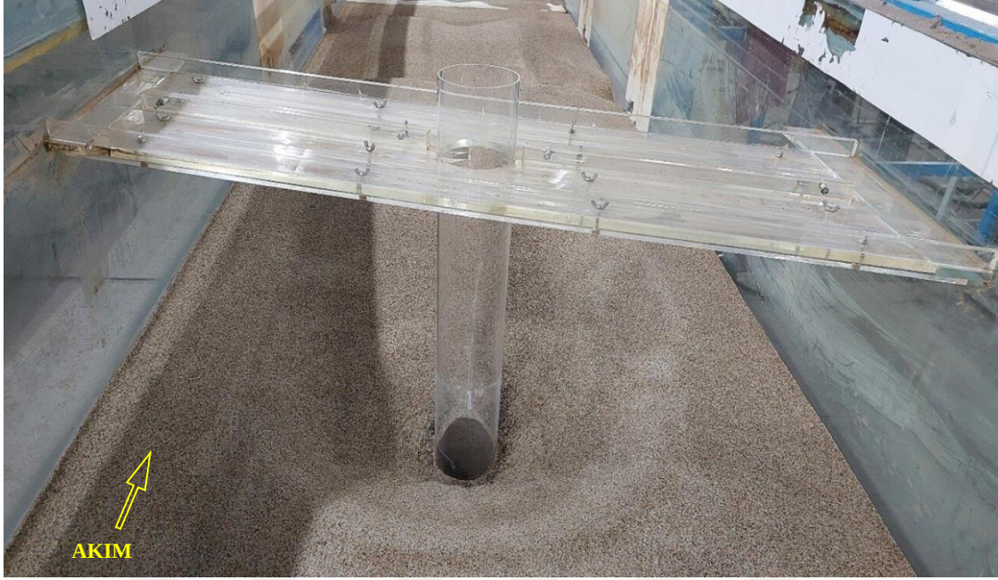
Resim 4.3. Tabliye ile orta ayağın bulunduğu kısmi basınçlı akım koşulunda meydana gelen taban oyulması
