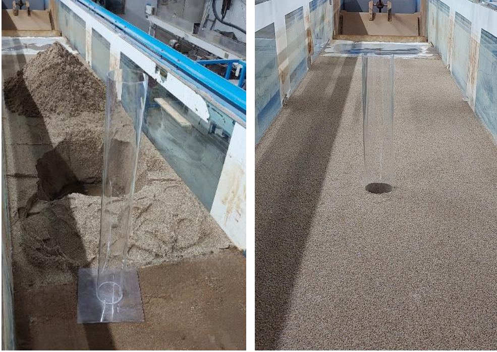
Resim 3.3. Deneylerde kullanılan silindirik orta ayağın konumlandırılması
