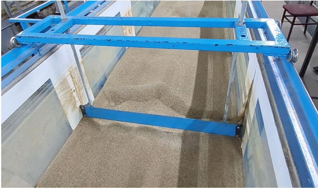
Resim 3.2. Taban malzemesi tesviyesinin sağlanmasında kullanılan aparat
