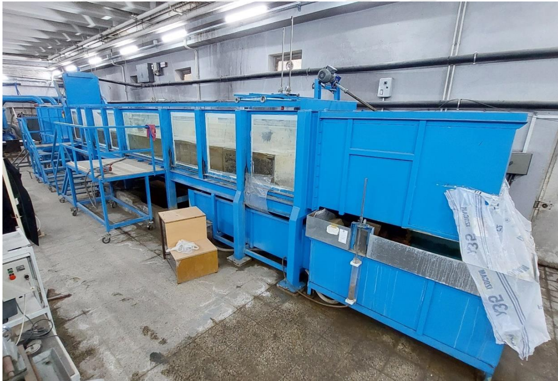
Resim 3.1. Çalışmalar kapsamında kullanılan açık kanal düzeneği
