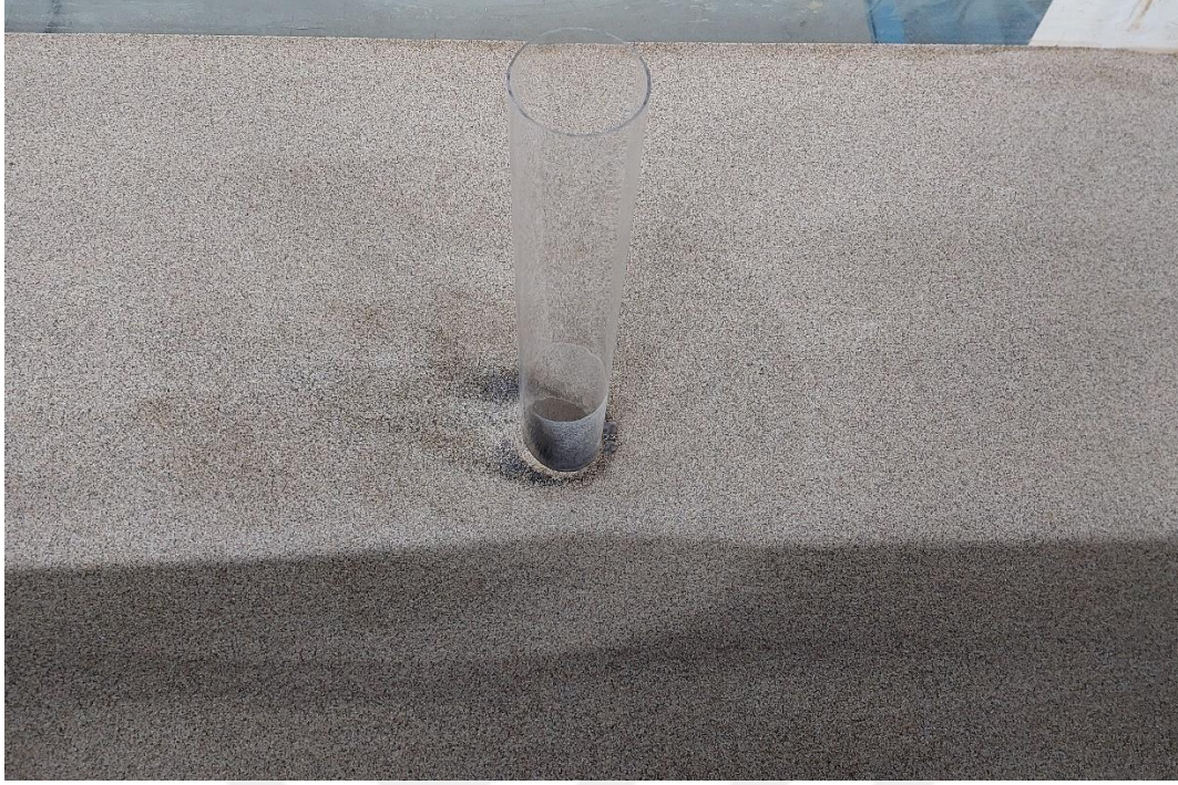
Resim 4.2. Serbest akım durumunda köprü ayağı etrafındaki yerel oyulmaları incelemek üzere yerleştirilen silindirik orta ayak
