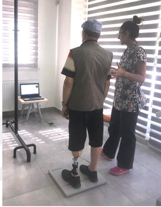
Şekil 3.3. Bertec kuvvet platformunda denge değerlendirmesi
