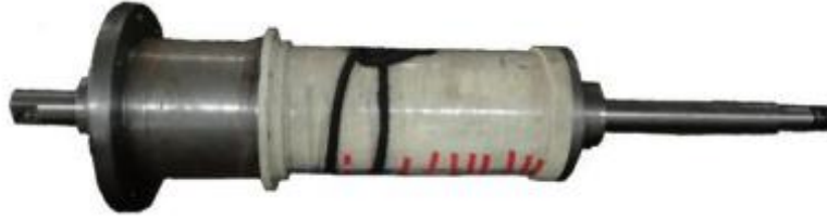
Şekil 1.20 Zhao ve arkadaşları tarafından tasarlanan oluklu tübüler kalıcı mıknatıslı doğrusal motor [33]
