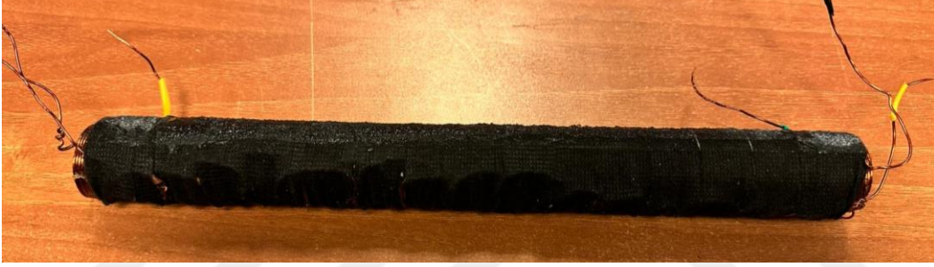
Şekil 4.12 Yataklanan ve kumaş bant ile sarılan stator
