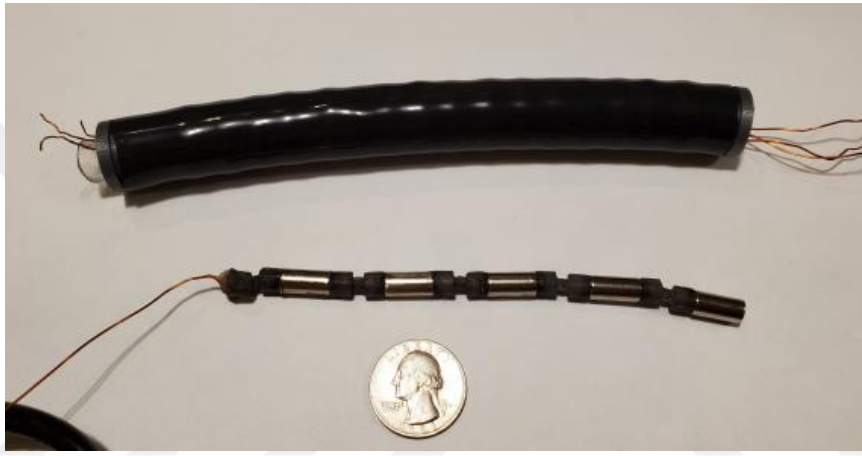
Şekil 1.22 Woodroffe'nin esnek motor çalışması [22]
