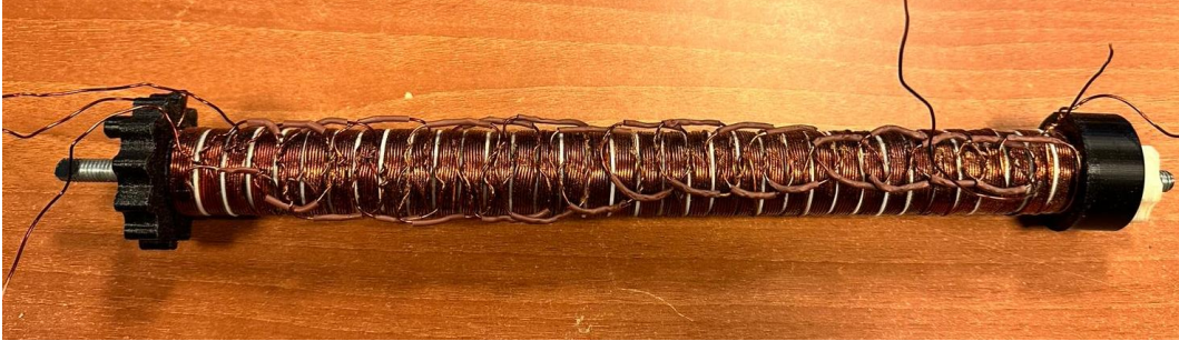
Şekil 4.11 Lehimleme ve makaronlama işlemi yapılan stator
