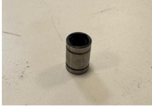
Şekil 4.14 Milin yataklanması için kullanılan 5 mm'lik doğrusal rulman
