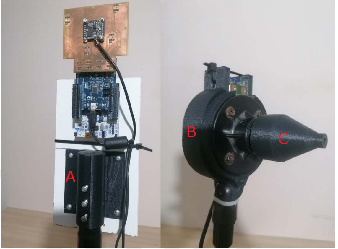
Şekil 3.15. 3D yazıcı ile baskısı yapılan mekanik aparatlar
