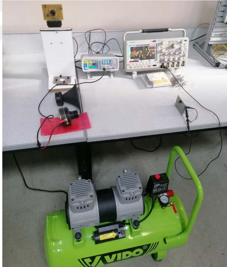
Şekil 3.9. Hava kaçağı benzetim düzeneği
