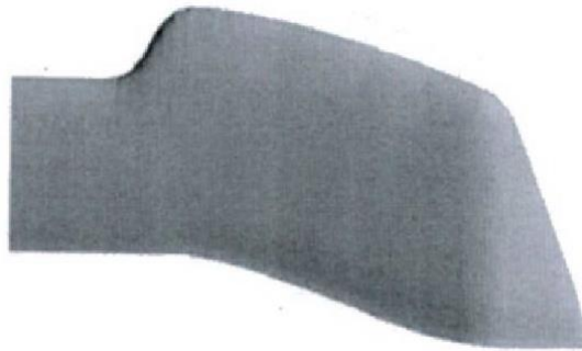
Şekil 1.10 : İngiliz Deneysel Rotor Programı Westland BERP-III Ucu
