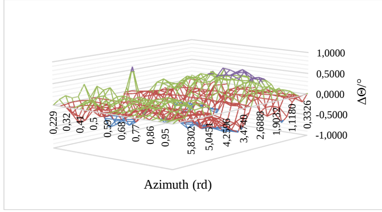
Şekil 4.15 : Bu çalışmada Pala-4 elastik burulma yaklaşım ve deney sonuçları farkları
