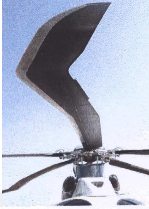
Şekil 1.79 : EuroCopter Blue Edge Blade (2011) [257].
