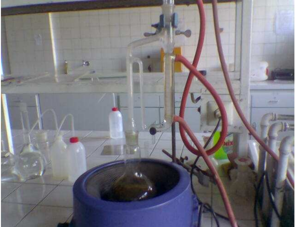
Şekil 3.2: Clevenger aparatı ile hidrodestilasyon.
