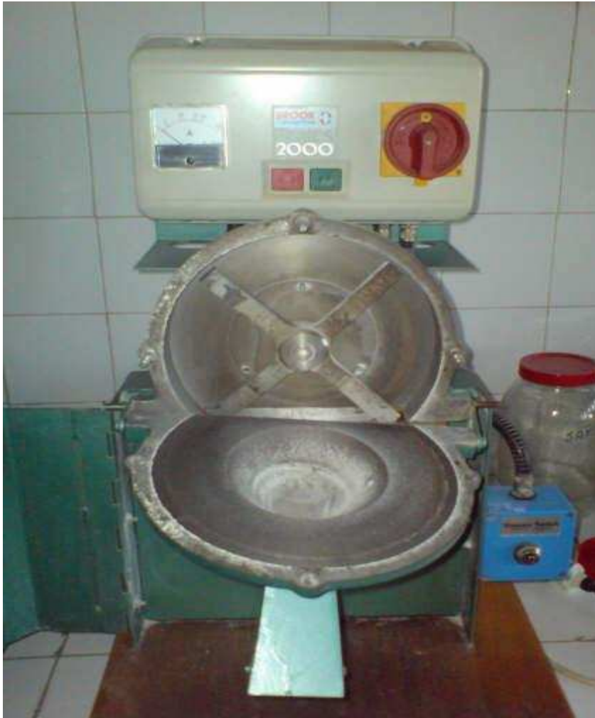
Şekil 3.1: O. onites L. örneklerini öğütmede kullanılan Brook Crompton Series 2000 marka öğütücü.
