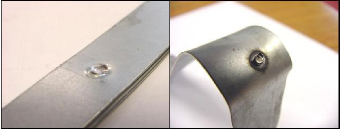
Şekil 5.18: Elektrod Ucunun Aynı Eksende Basmadığı Durumda Soyma Deneyi
