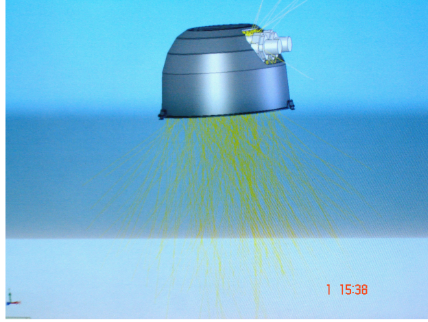
Şekil 4.4 : Lambadan çıkan 1000 ışın için yansıtıcı tasarımı.
