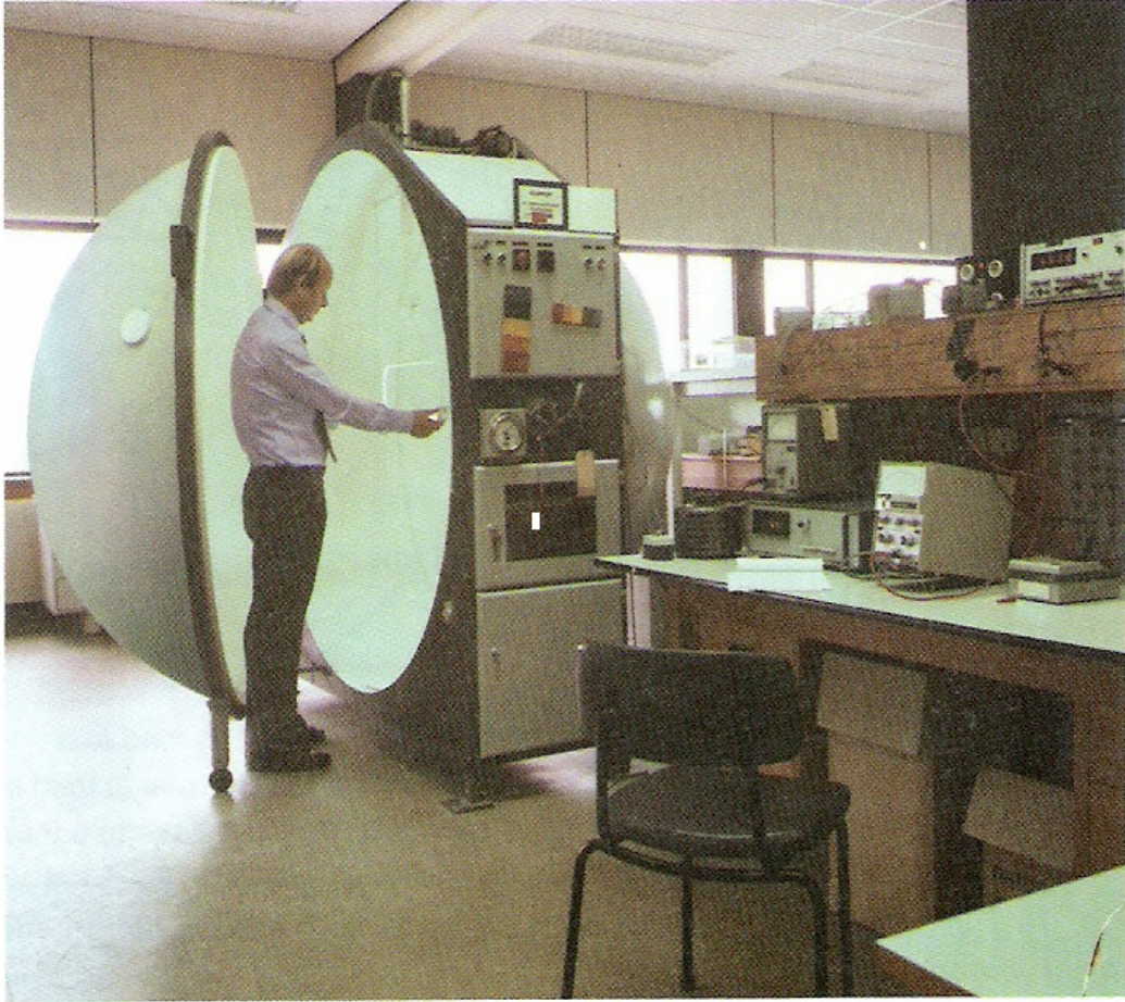
Şekil 3.25 : Işık akısı ölçmek için kullanılan Ulbricht küre fotometresi.
