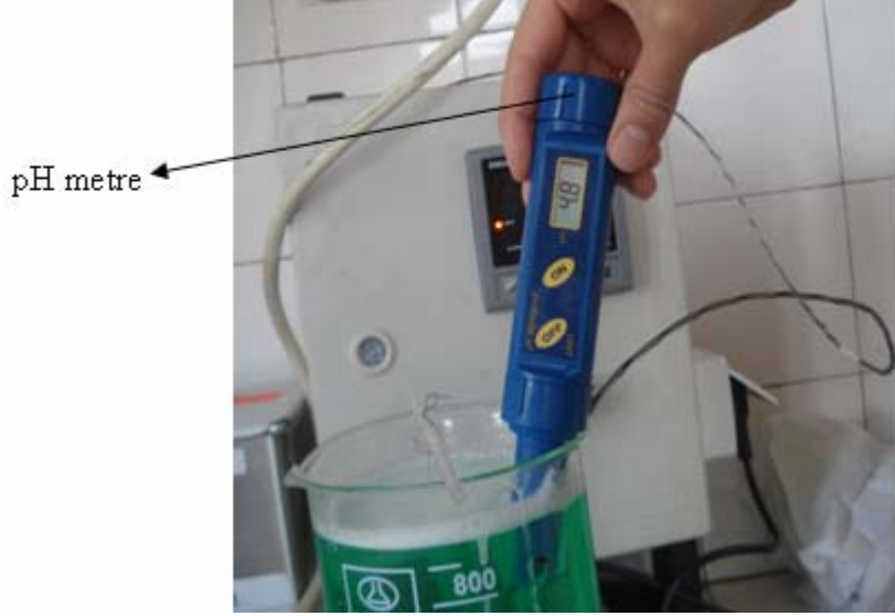
Şekil 8.2: Ni-P Banyosunda pH Kontrolü
