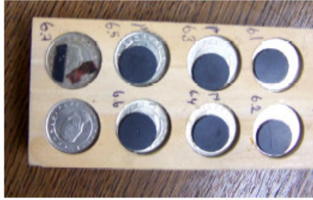
Fotoğraf 3.2 Deneyde kullanılan Zn ilaveli BiP bSrCaCuO tabletler
