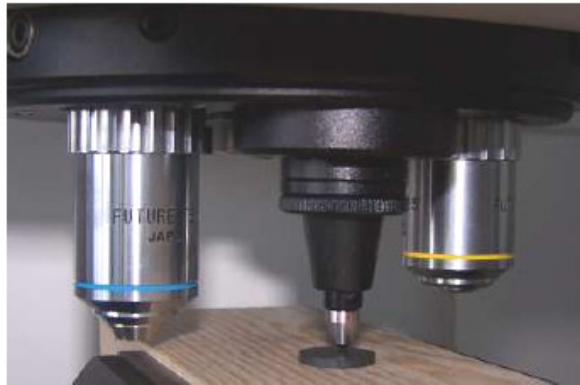
Fotoğraf 3.1 Vickers sertlik ölçüm test cihazının Zn katkılı BiP bSrCaCuO süperiletkeni üzerine yük uygularkenki görünümü
