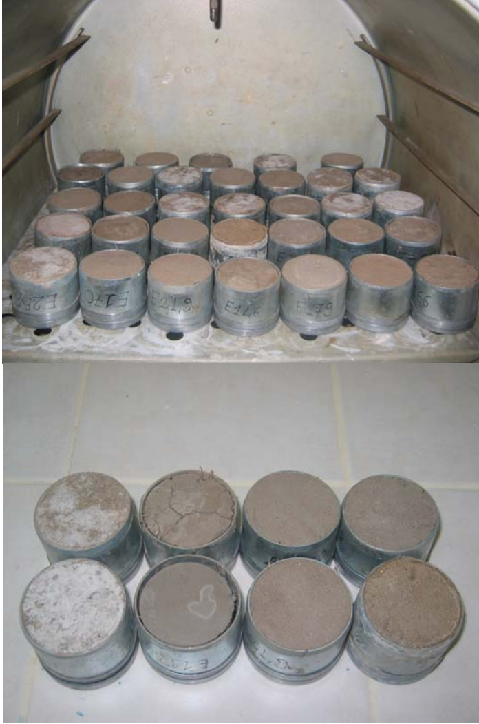
Şekil 6.16. Gravimetrik yöntem ile nem ölçümü yapılmasında kullanılan çelik silindirler ve otoklavda kurutulması
