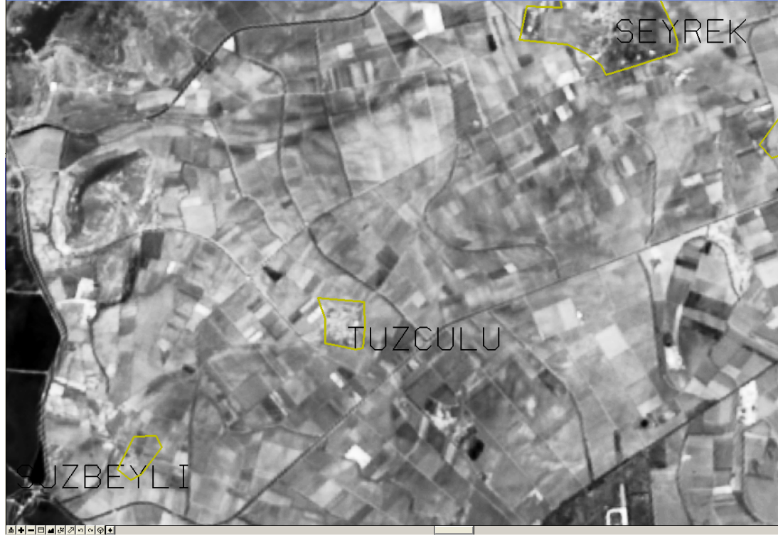
Şekil 7.36. Spot 3. band (NIR) ve RADARSAT-1 görüntüsünden birleştirme (fusion) yöntemi ile üretilen görüntüde nemin belirlenmesi
