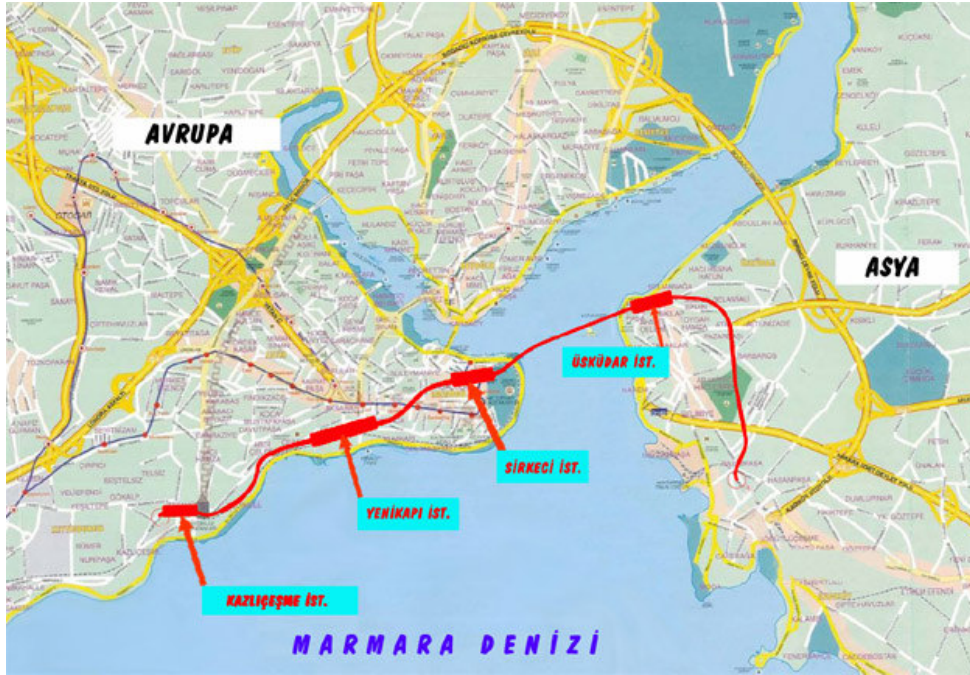
Şekil 3.2: Marmaray Projesin'deki Yer Altı İstasyonlarının Yerleşimi [4]
