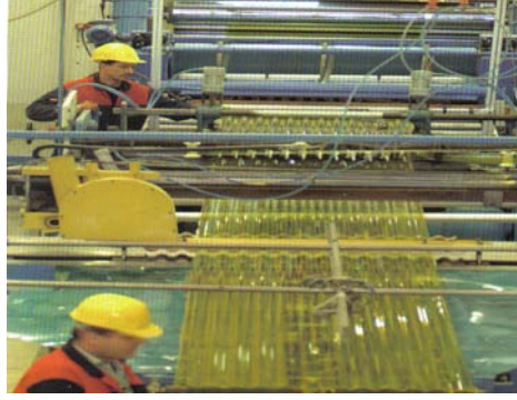
Şekil 3.50: Oluklu PVC levha üretimi[30] Şekil 3.51: Su tutucu bant olarak PVC[44]
