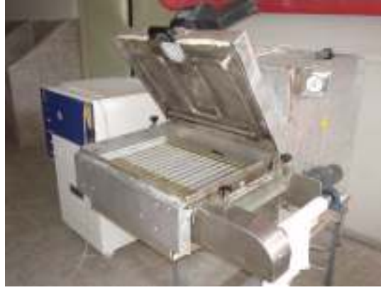
b) Buhar jeneratörü ve Stray-Field elektrot sistemi uygulana 1 kW'lık RF kurutucu
