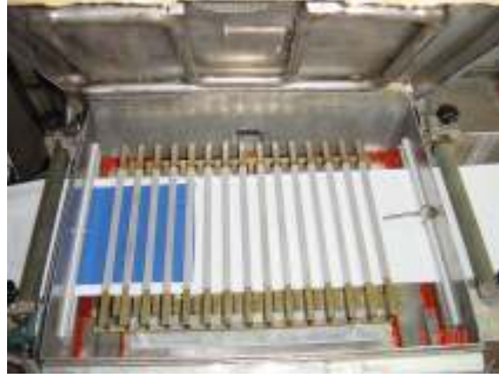
Şekil 5.1 a) Staggered Stray-Field elektrot sistemi uygulana 1 kW'lık RF kurutucu
