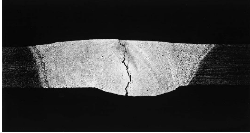
Şekil 4.5: 3 mm kalınlığında A6082 ana metal/4043 dolgu metali kullanılarak TIG yöntemiyle yapılmış kaynakta meydana gelen sıcak çatlak [1]
