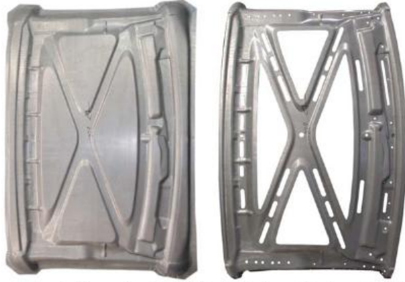
Şekil 4.2: Magnezyum levhadan üretilmiş otomobil parçaları (sol: şekillendirilme sonrası, sağ: kesme sonrası) [22].
