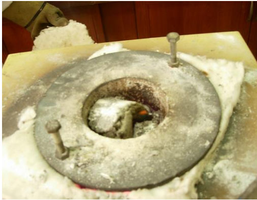
(b) : Taç magnezyumun ergitilmesi
