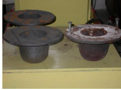
Şekil 7.7 (a) : Taç (crown) magnezyumun ergitildiği dökme demir potalar
