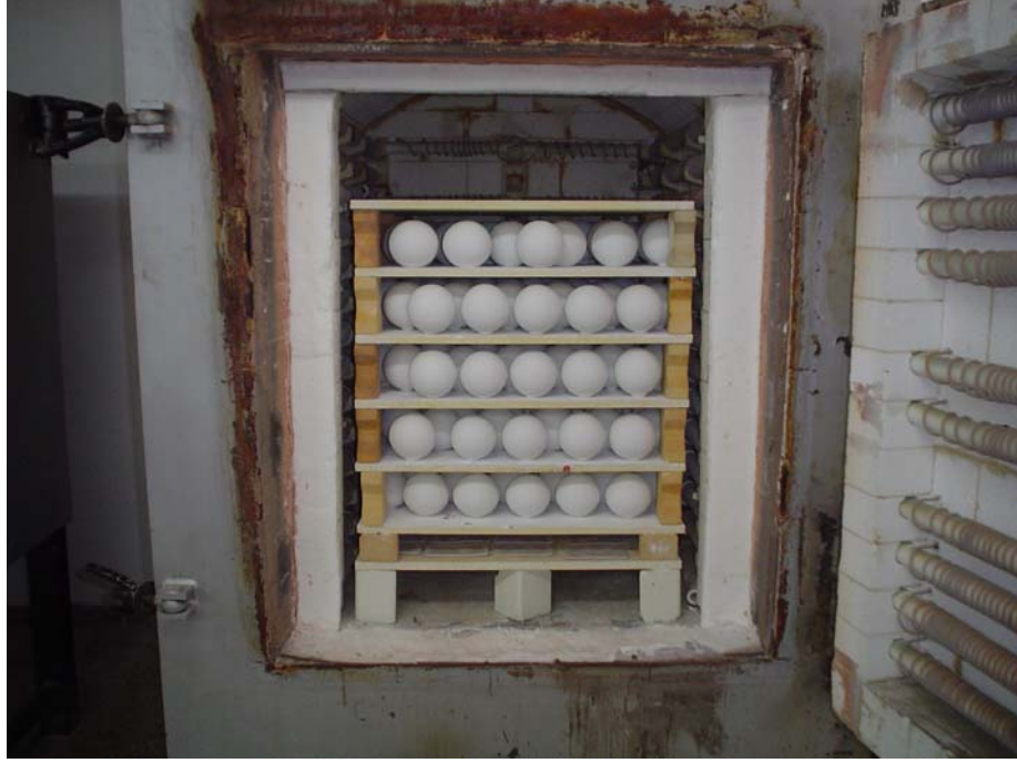
Resim 178. Fırının sırlı pişirim için doldurulması.
