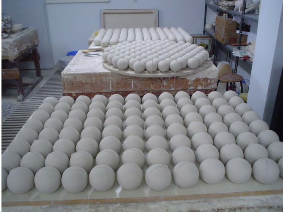
Resim 150. Dökümlerin kalıptan çıkarıldıktan sonra kurumaya bırakılması.
