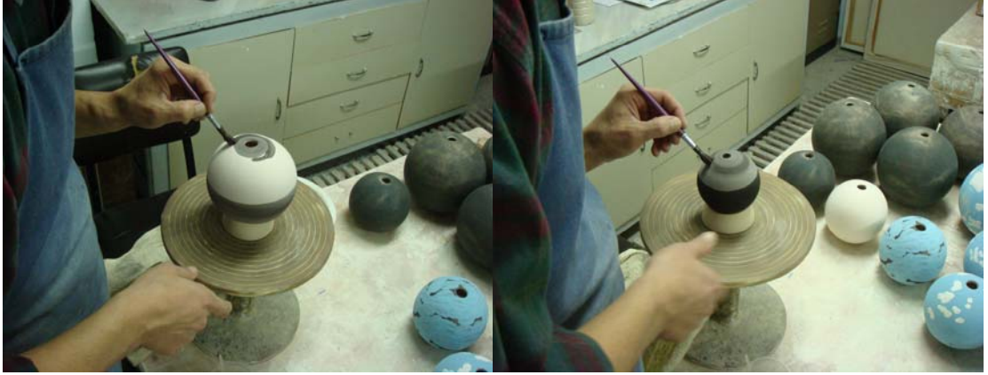
Resim 162,163. Ürünlerin fırça ile sır ve dekorlarının yapılması.
