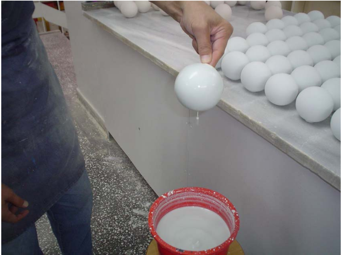
Resim 170,171. Daldırma yöntemi ile ürünlerin sırlanması.
