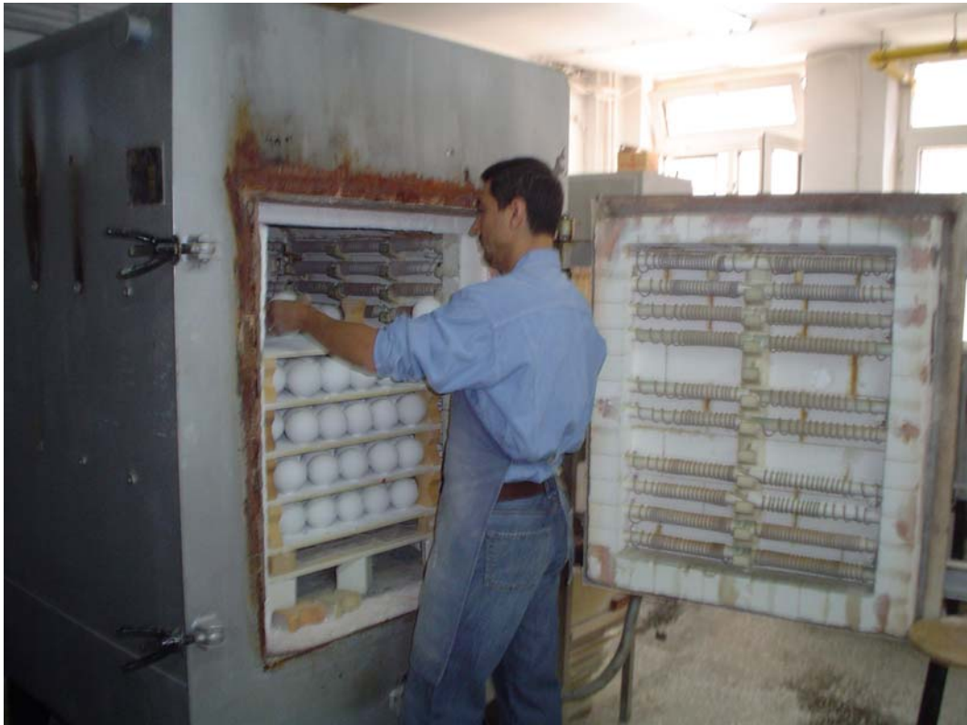
Resim 177. Fırının sırlı pişirim için doldurulması.
