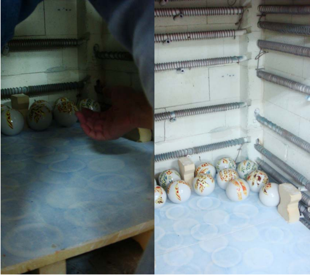
Resim 185,186. Dekor pişirimi için fırının doldurulması.
