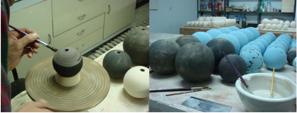
Resim 164,165. Ürünlerin fırça ile sır ve dekorlarının yapılması.
