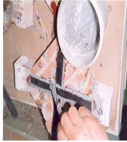
Şekil 5.10. Numunelere Şerit CFRP Uygulaması
