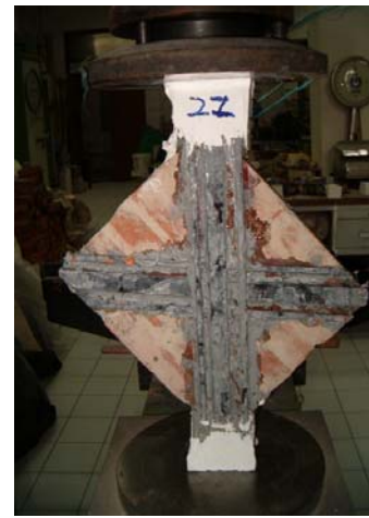
Şekil 5.18. Hasarsız Numunenin Ayrık Şerit CFRP Uygulaması
