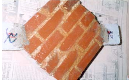
Şekil 3.5: Tuğla Duvar Yüzeyine Astar Uygulaması
