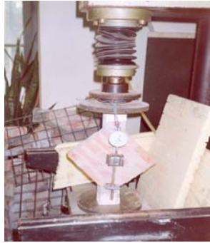
Şekil 5.1: Yalın Tuğla Duvar Örneklerinin Yükleneş
