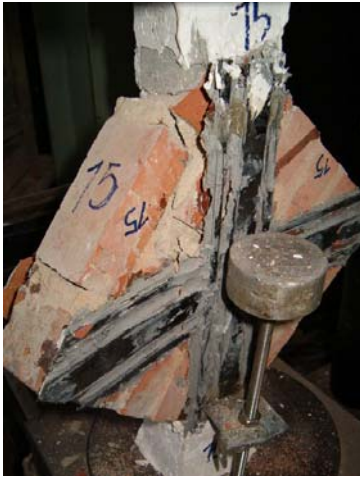
Şekil 6.19: Seri II Numunesinin Kırılma Mekanizması
