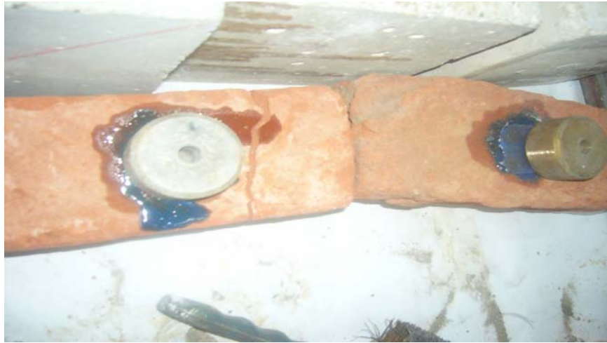
Şekil 3.11: Dokuma CFRP Yapıştırıcısı ile Tuğla Yüzey Arasındaki Kopma Mekanizmaları
