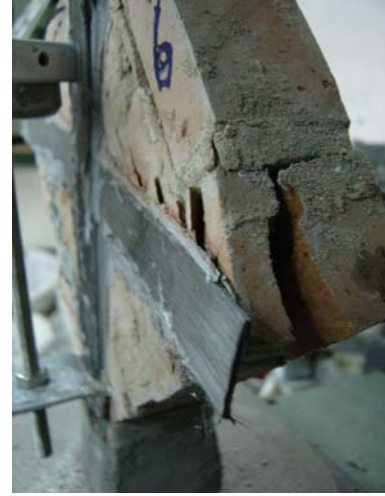
Şekil 6.12: Seri I Numunelerinin Tipik Kırılma Mekanizması Detayı
