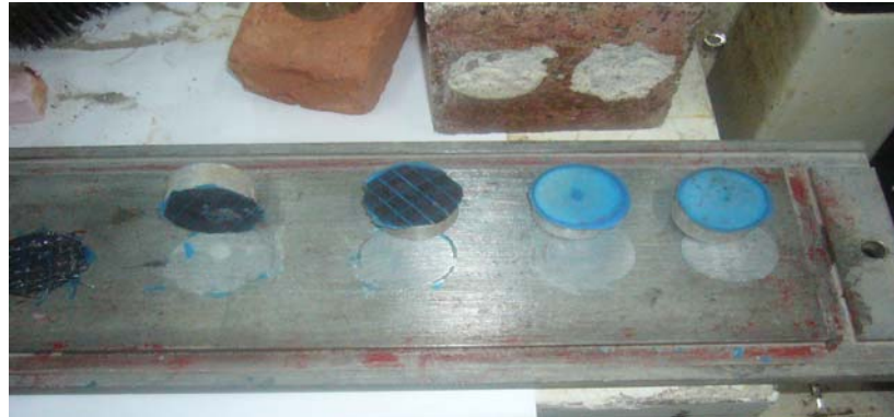
Şekil 3.13: Dokuma CFRP Yapıştırıcısı ile Çelik Yüzey Arasındaki Kopma Mekanizmaları
