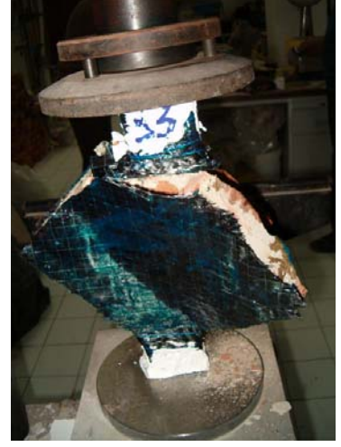
Şekil 5.31. Seri III-Güçlendirilen Numunenin Yükleme Sonrası ( Ön Yüz)
