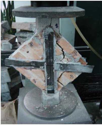
Şekil 6.11: Seri I Numunelerinin Tipik Kırılma Mekanizmaları
