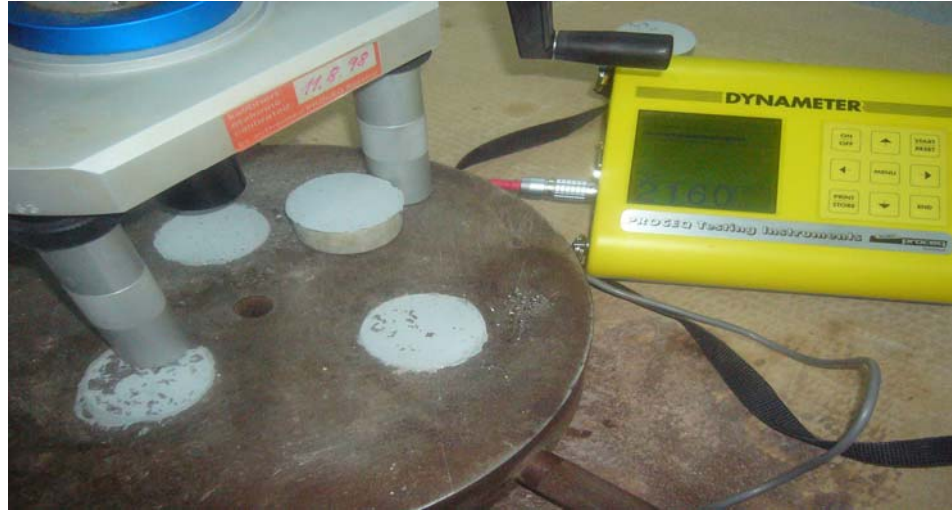
Şekil 3.10: Şerit CFRP Yapıştırıcısı ile Çelik Yüzey Arasındaki Kopma Mekanizmaları
