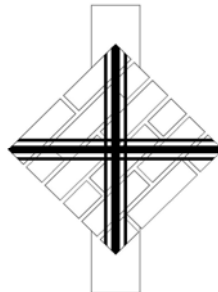
Şekil 5.11. Seri II-Tuğla Duvarların Güçlendirme Şekli
