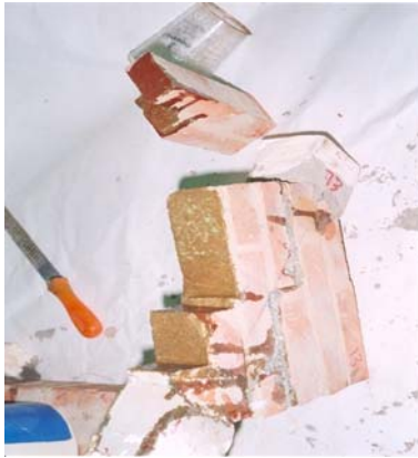
Şekil 6.3: Yalın Tuğla Duvar Örneklerinin Göçme Mekanizması
