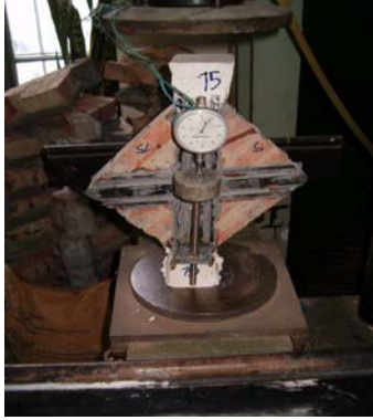
Şekil 5.28. Seri II-Güçlendirilen Numunenin Yükleme Öncesi (Ön Yüz)
