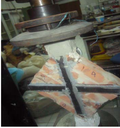
Şekil 5.9. Hasarlı Numunenin Şerit CFRP Uygulaması
