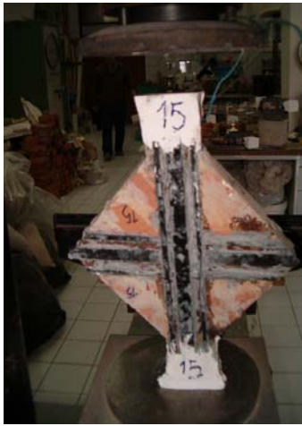
Şekil 5.17. Hasarlı Numunenin Ayrık Şerit CFRP Uygulaması
