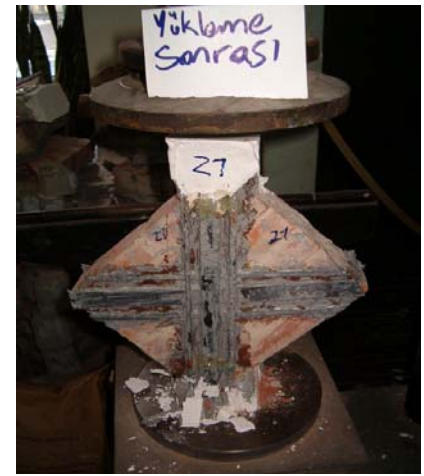
Şekil 6.20: Seri II Numunesinin Yükleme Sonrası Görünüşü
