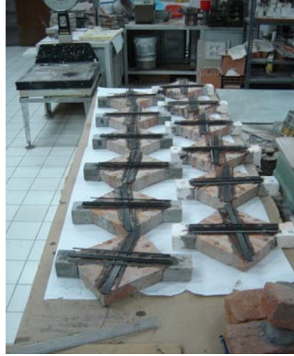
Şekil 5.16. Dağınık Şerit CFRP Uygulama Hazırlığı
