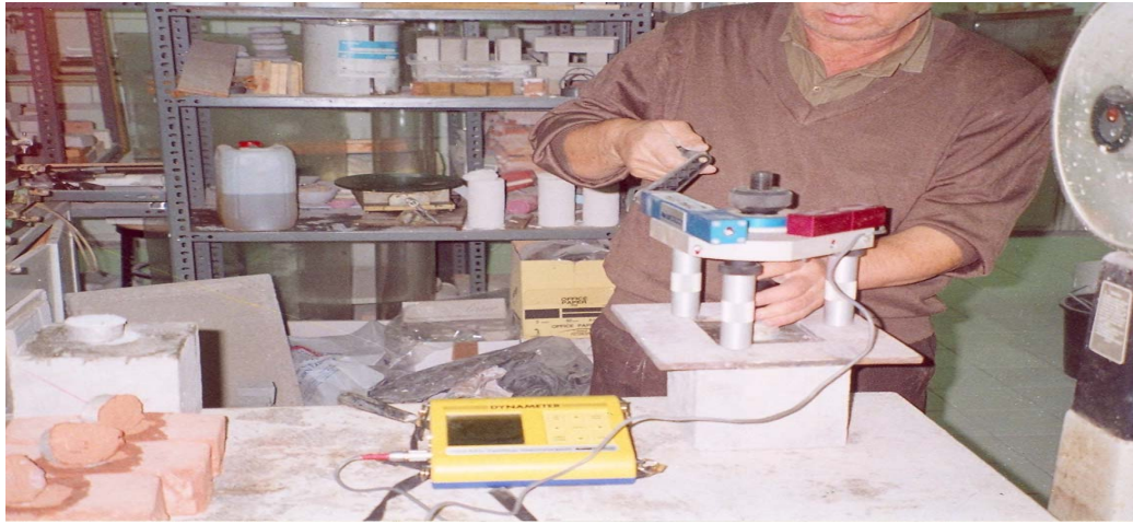
Şekil 3.6: Aderans Deneyi Düzeneği (Pull Off Test cihazı)
