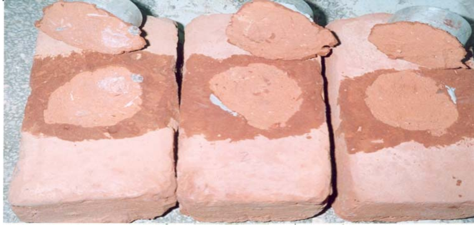
Şekil 3.8: Şerit CFRP Yapıştırıcısı ile Tuğla Yüzeyin Kopma Mekanizmaları
