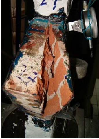
Şekil 6.27: Seri III Numunesinin Göçme Mekanizması
