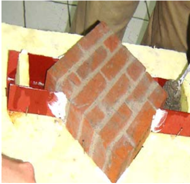
Şekil 4.5: Numunelere Başlık Uygulaması
