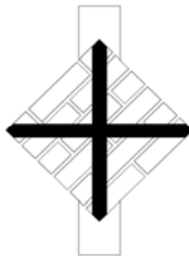
Şekil 5.3: Seri I-Tuğla Duvarların Güçlendirme Şekli
