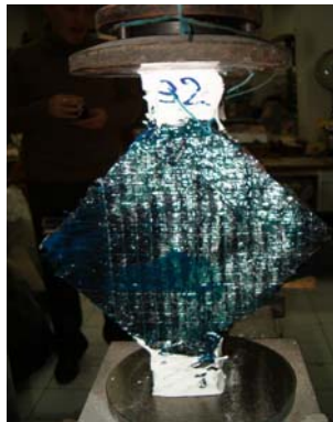
Şekil 5.24. Dokuma CFRP'nin Uygulama Örneği
