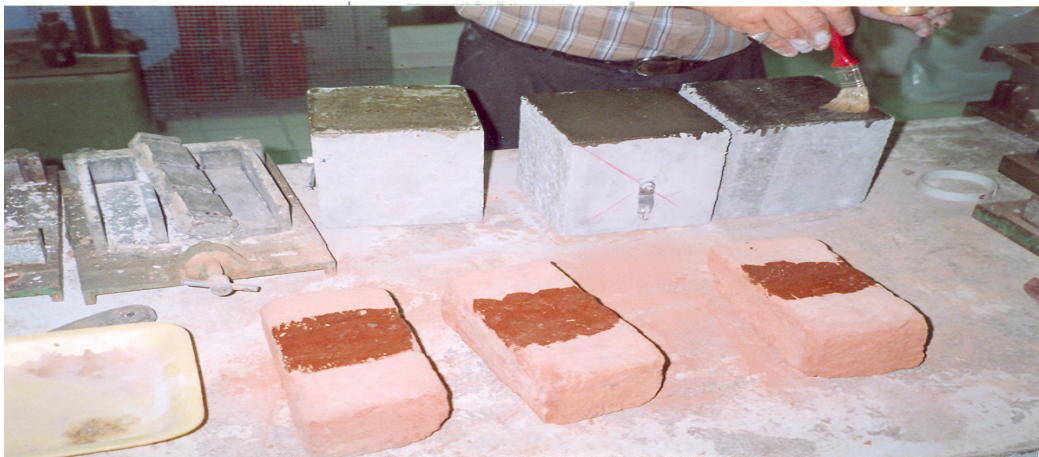
Şekil 3.7: Tuğla, Beton Yüzeylerde Astar Uygulaması
