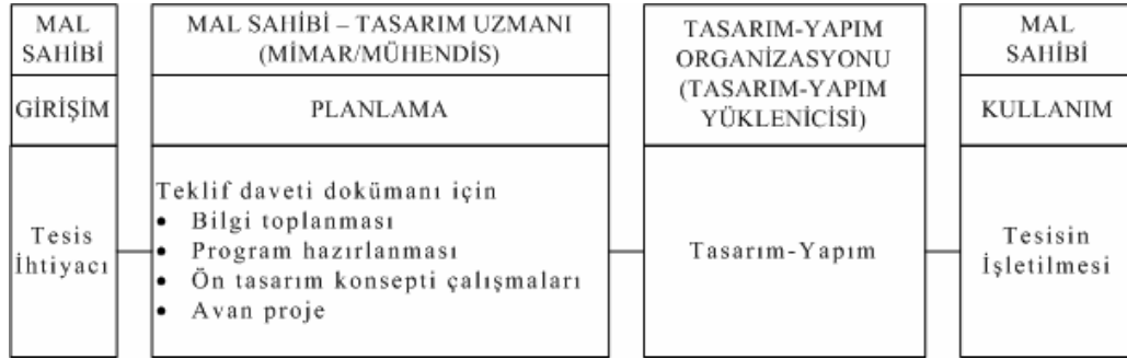
Şekil 2.8: Avan Projesi Olan Tasarım-Yapım Proje Teslim Sistemi Süreç Şeması
