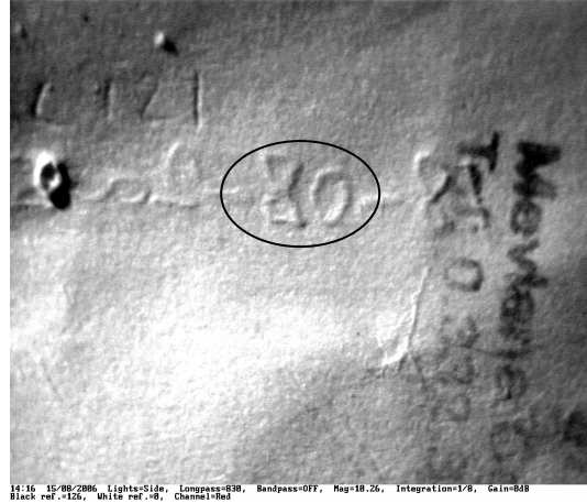
Esda cihazı yardımıyla fulaj izi farklılığı görüntüsü
